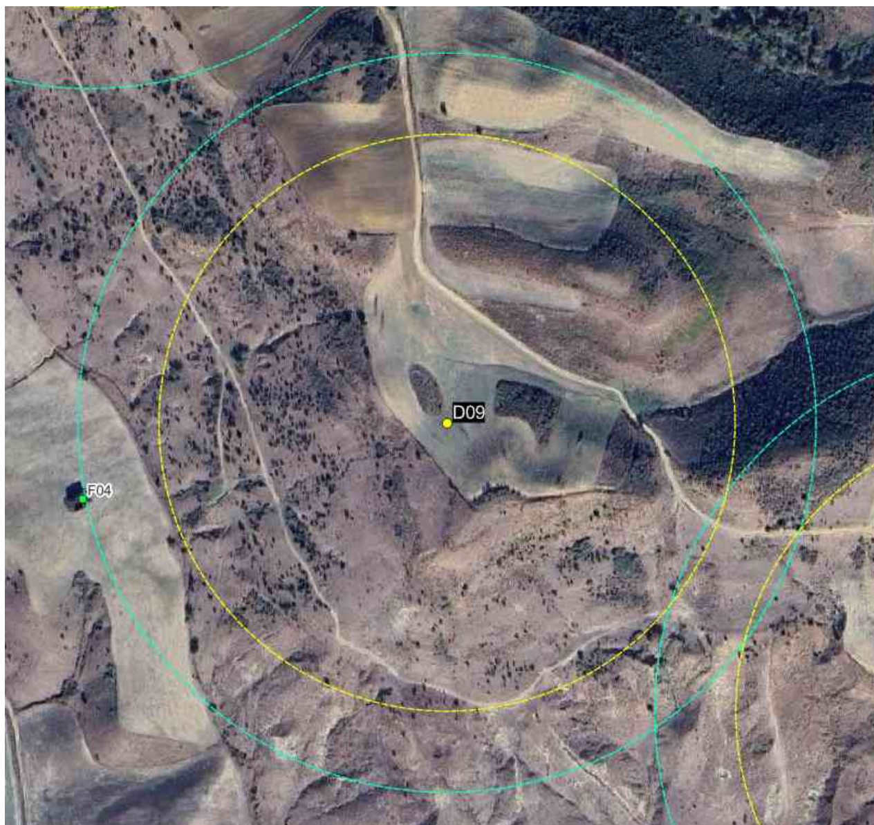
Figura 8-10 – Gittata dell'intera pala (246,6 m) in colore giallo e gittata del frammento di pala (316,0 m) in colore verde, da aerogeneratore D09
