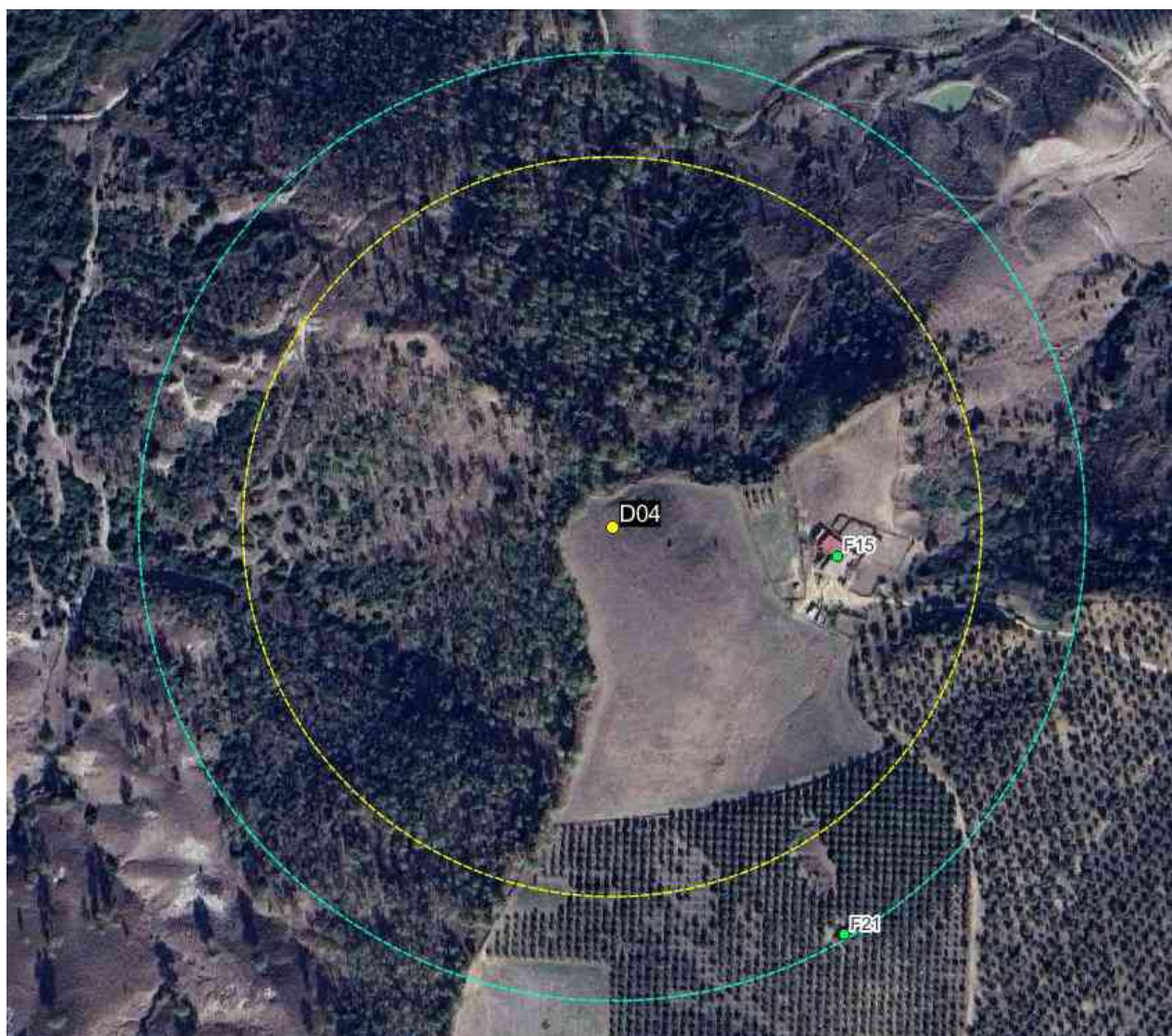
Figura 8-5 – Gittata dell'intera pala (246,6 m) in colore giallo e gittata del frammento di pala (316,0 m) in colore verde, da aerogeneratore D04
