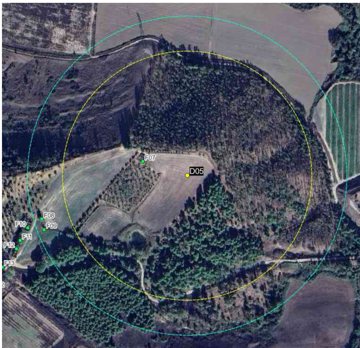
Figura 8-6 – Gittata dell'intera pala (246,6 m) in colore giallo e gittata del frammento di pala (316,0 m) in colore verde, da aerogeneratore D05
