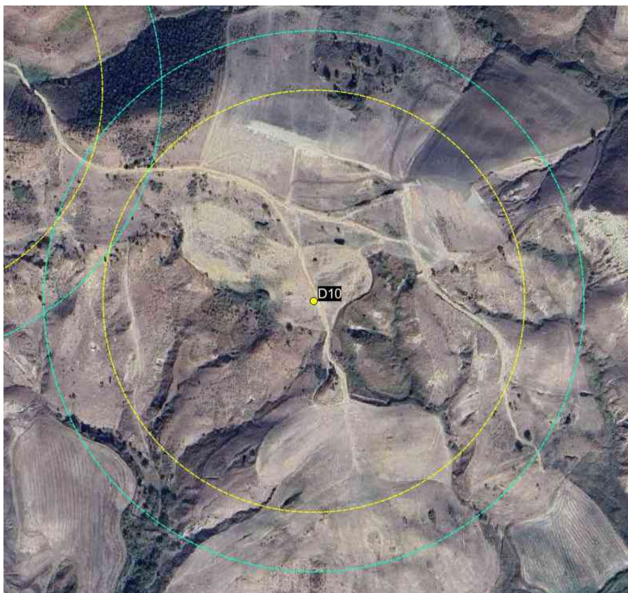
Figura 8-11 – Gittata dell'intera pala (246,6 m) in colore giallo e gittata del frammento di pala (316,0 m) in colore verde, da aerogeneratore D10
