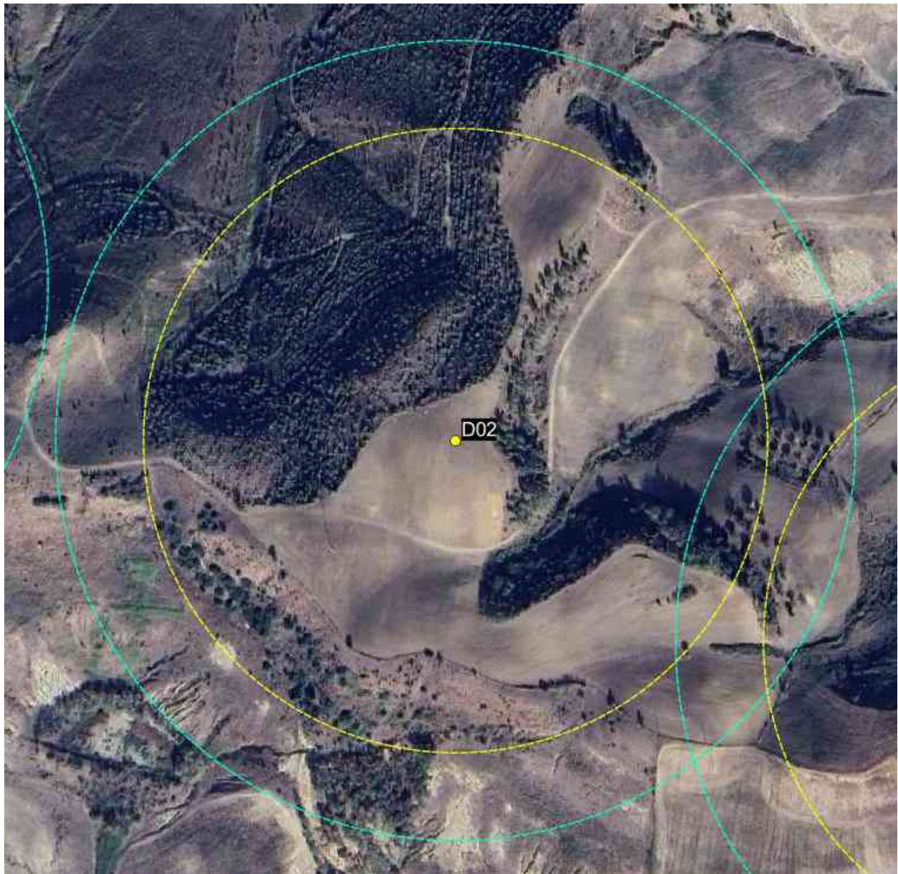
Figura 8-3 – Gittata dell'intera pala (246,6 m) in colore giallo e gittata del frammento di pala (316,0 m) in colore verde, da aerogeneratore D02
