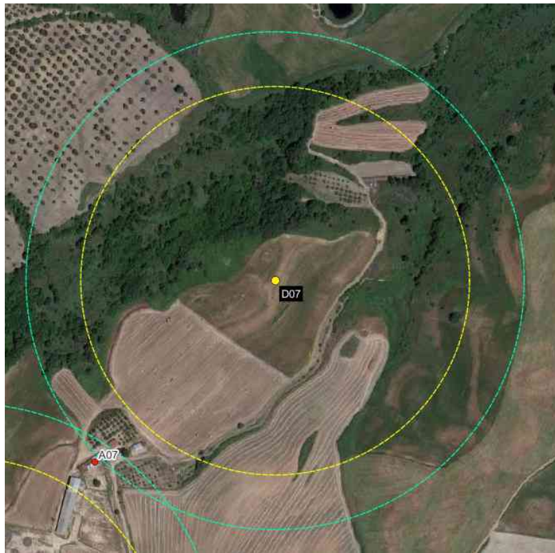
Figura 8-8 – Gittata dell'intera pala (246,6 m) in colore giallo e gittata del frammento di pala (316,0 m) in colore verde, da aerogeneratore D07
