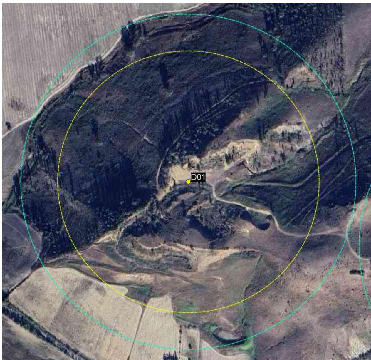
Figura 8-2 – Gittata dell'intera pala (246,6 m) in colore giallo e gittata del frammento di pala (316,0 m) in colore verde, da aerogeneratore D01
