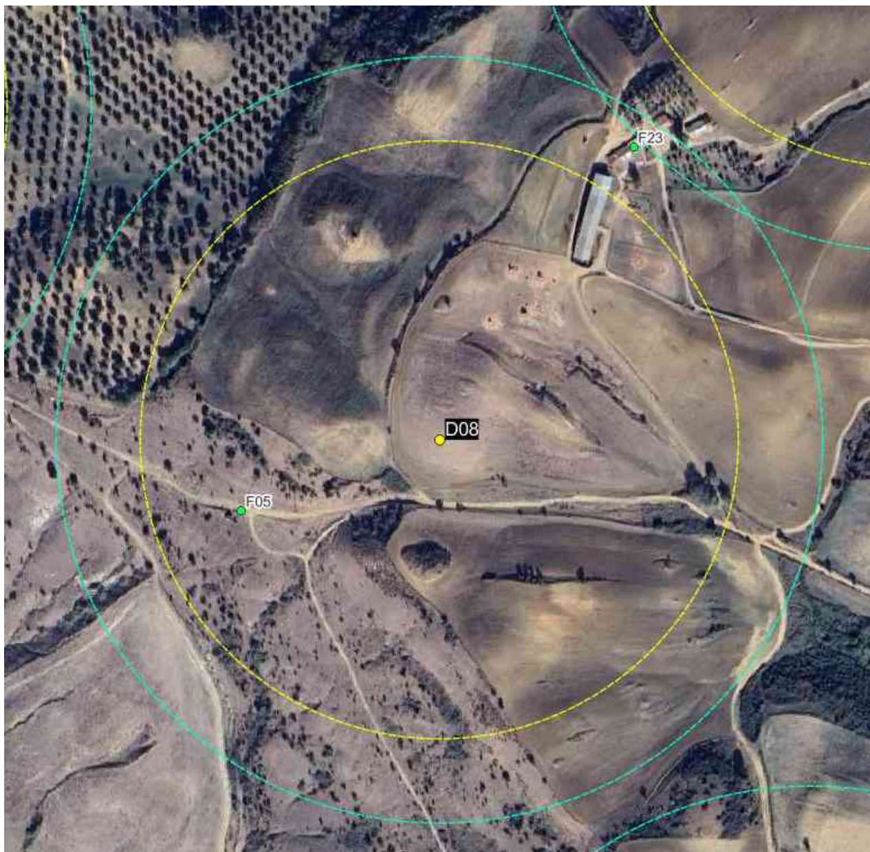
Figura 8-9 – Gittata dell'intera pala (246,6 m) in colore giallo e gittata del frammento di pala (316,0 m) in colore verde, da aerogeneratore D08
