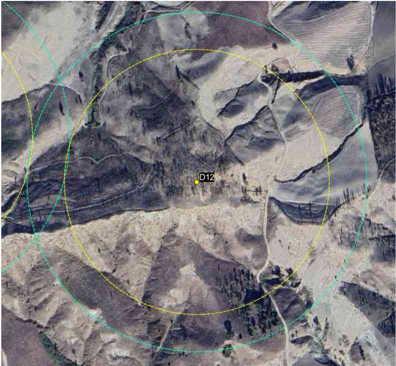
Figura 8-13 – Gittata dell'intera pala (246,6 m) in colore giallo e gittata del frammento di pala (316,0 m) in colore verde, da aerogeneratore D12
