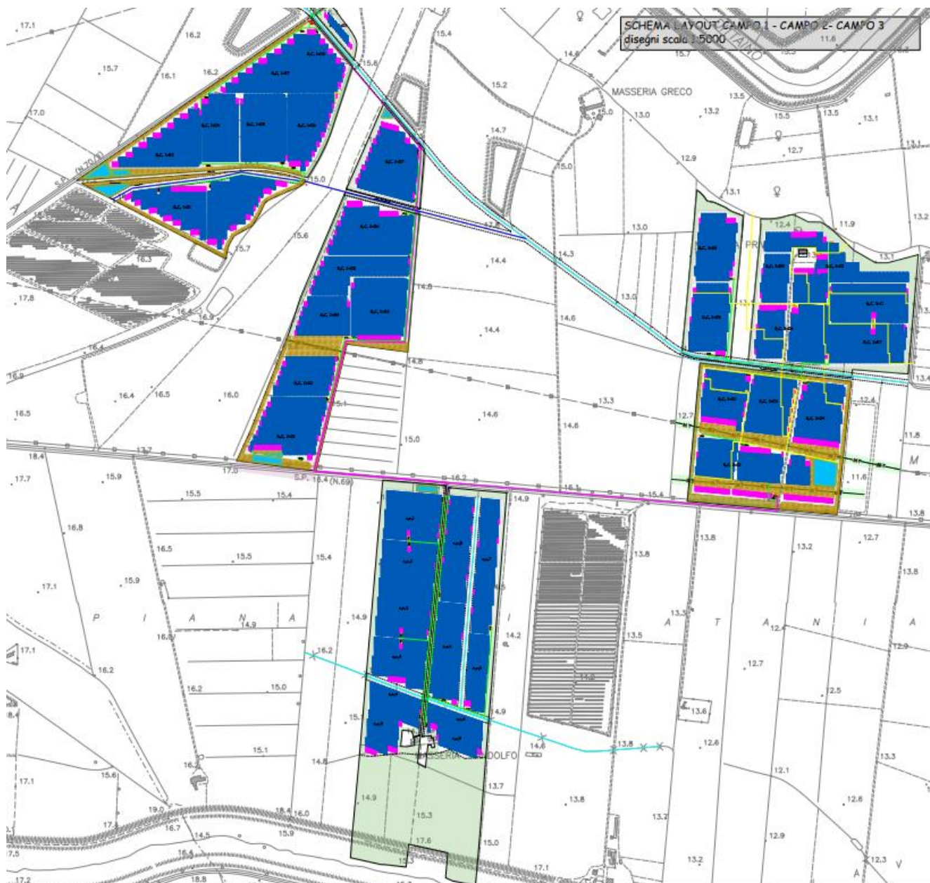
Figura 1 – Layout impianto fotovoltaico
