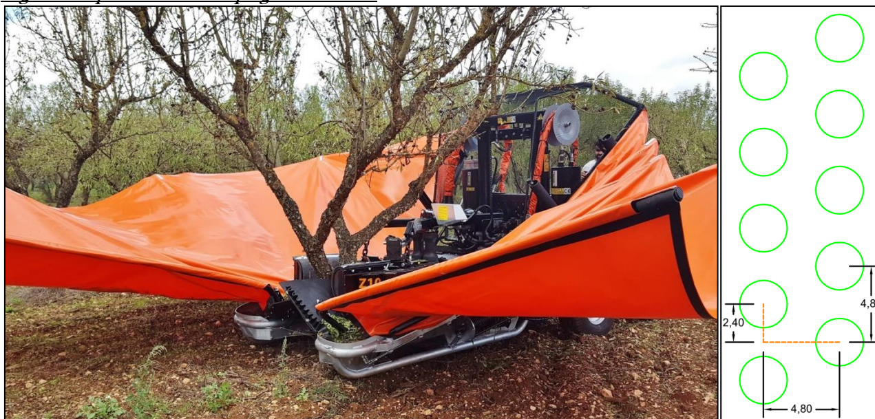
Figura 1.1 Macchina frontale per la raccolta delle olive/mandorle su impianto intensivo e disposizione ideale degli alberi per il corretto impiego della stessa
