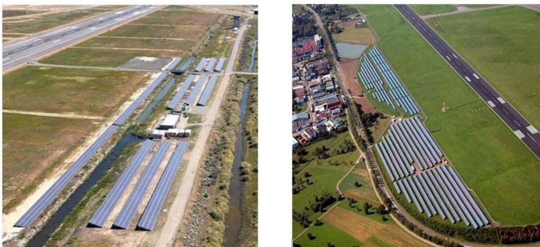
Esempi di impianti fotovoltaici in ambito aeroportuale. La disposizione dei moduli fotovoltaici in prossimità delle piste di atterraggio/decollo non rappresenta un rischio per la sicurezza
