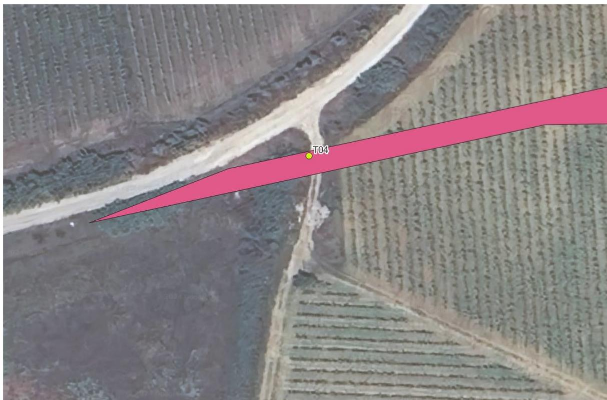
Figura 7.6: Interferenza T04. In magenta la viabilità di nuova realizzazione di accesso all'aerogeneratore CL03.
