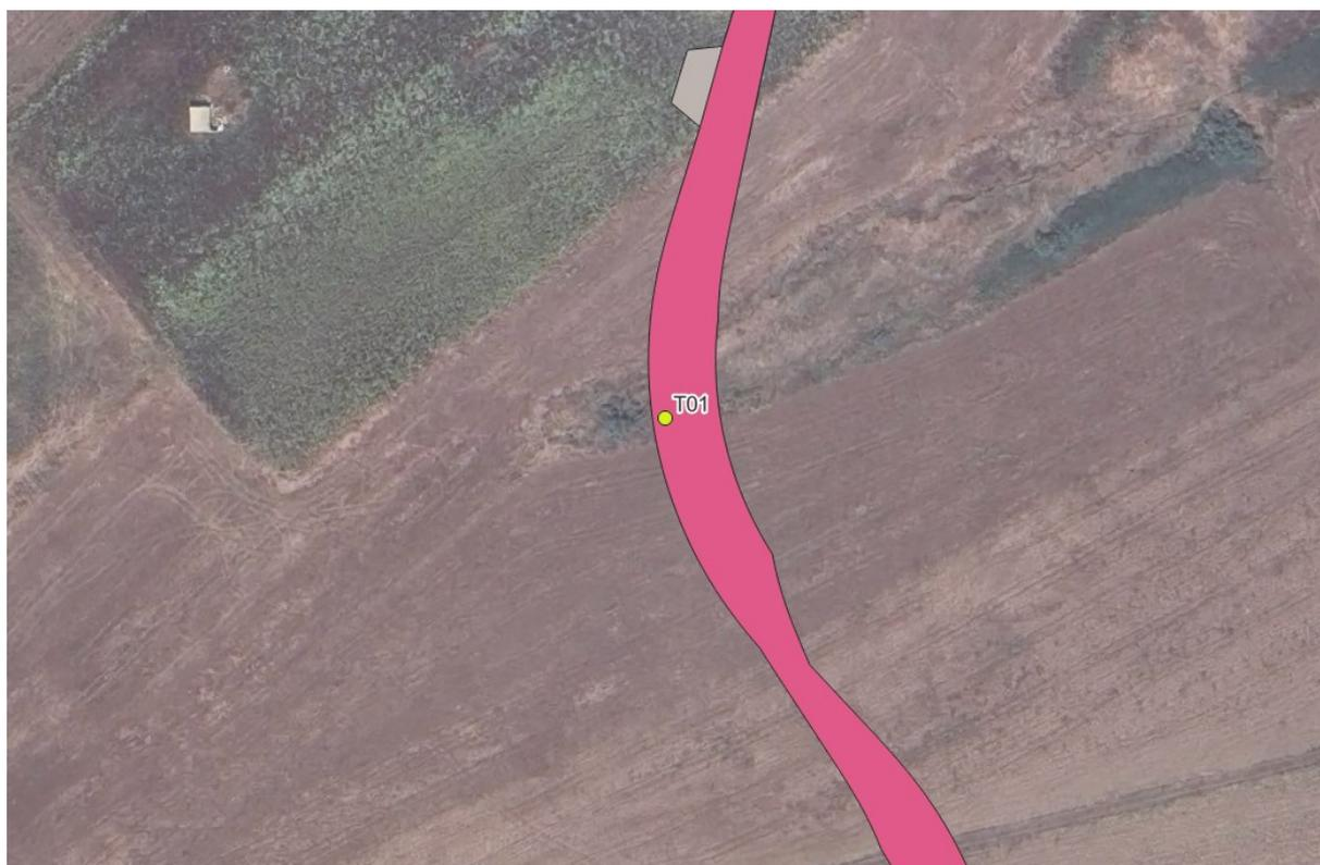
Figura 7.3: Interferenza T01. In magenta la viabilità di nuova realizzazione di accesso all'aerogeneratore CL03.
