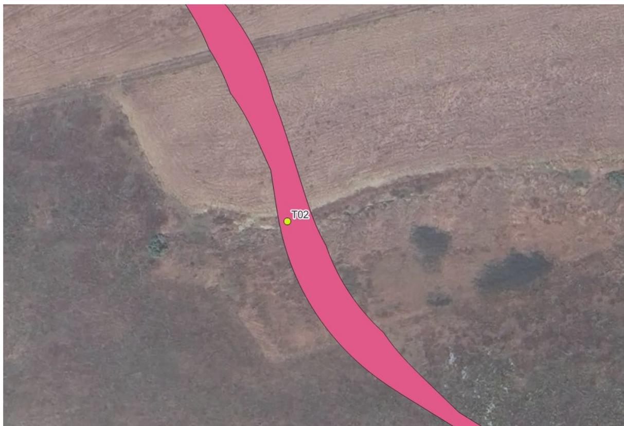
Figura 7.4: Interferenza T02. In magenta la viabilità di nuova realizzazione di accesso all'aerogeneratore CL03.
