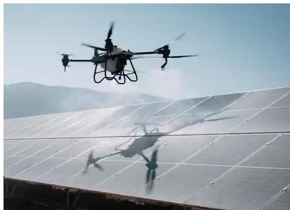
*Figura 50 – Esempi di pulizia meccanica tramite droni*
