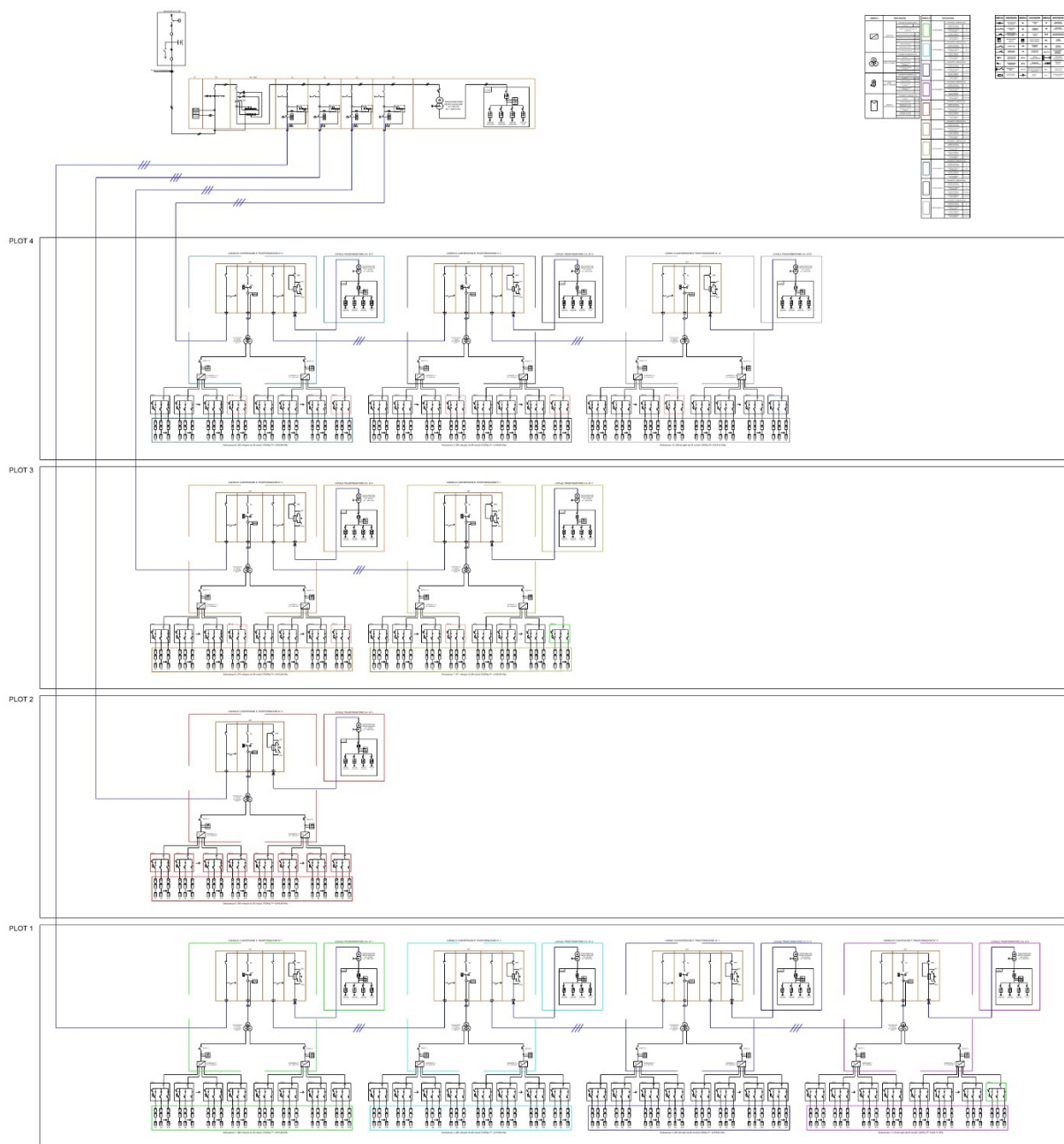
Figura 8: schema dell'impianto di produzione, con indicazione dei plot e delle linee a 36 kV di interconnessione, della cabina di raccolta e della dorsale a 36 kV di collegamento con la Stazione Elettrica.
