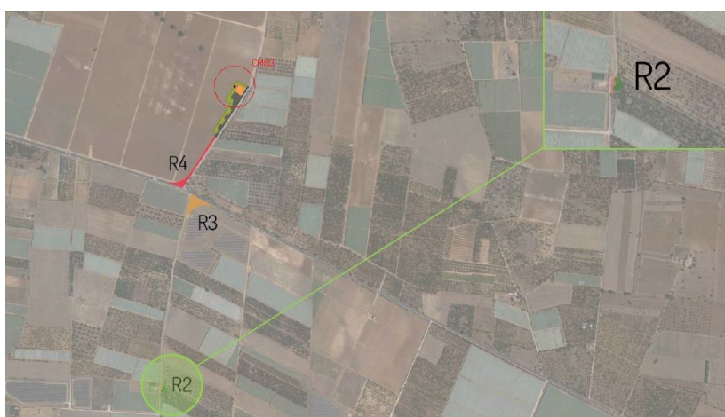
Figura 14: tratto di strada che sarà soggetto ad adeguamento per il passaggio di mezzi speciali
