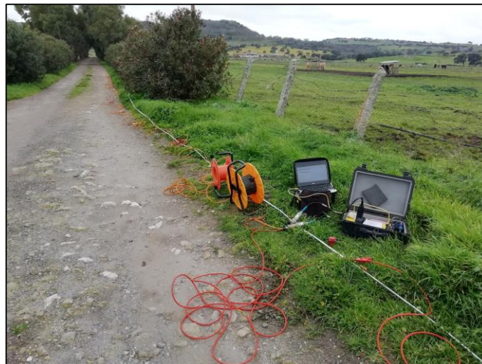
Figura 12.6 - esecuzione indagine sismica MASW
