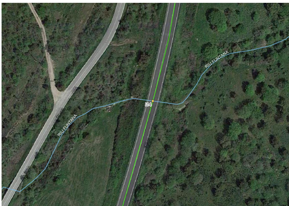
Figura 6.31 - Ubicazione interferenza I14 su ortofoto, in verde il cavidotto di connessione, in azzurro la rete idrica
