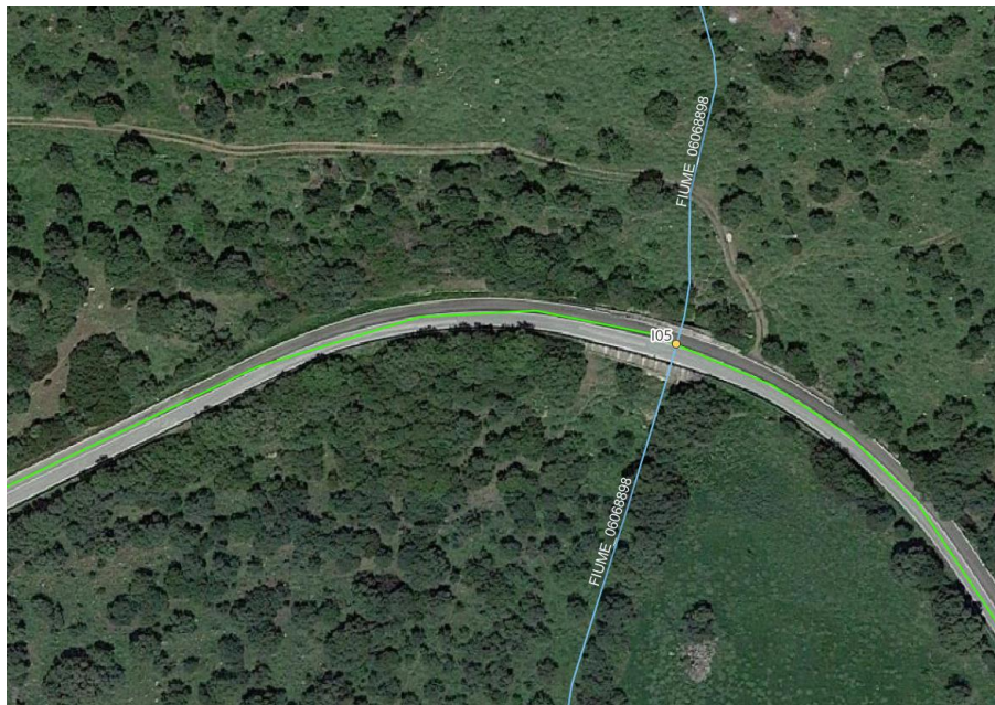
Figura 6.13 - Ubicazione interferenza I05 su ortofoto, in verde il cavidotto di connessione, in azzurro la rete idrica
