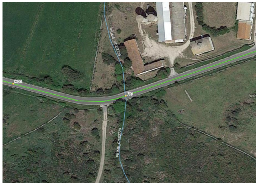
Figura 6.23 - Ubicazione interferenza I10 su ortofoto, in verde il cavidotto di connessione, in azzurro la rete idrica
