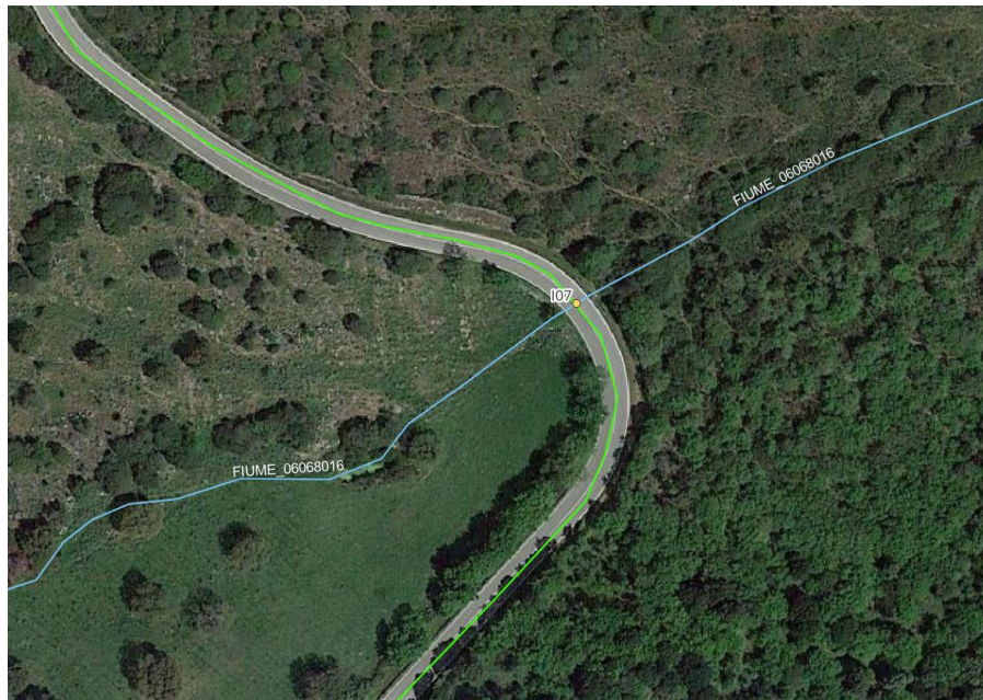
Figura 6.17 - Ubicazione interferenza I07 su ortofoto, in verde il cavidotto di connessione, in azzurro la rete idrica
