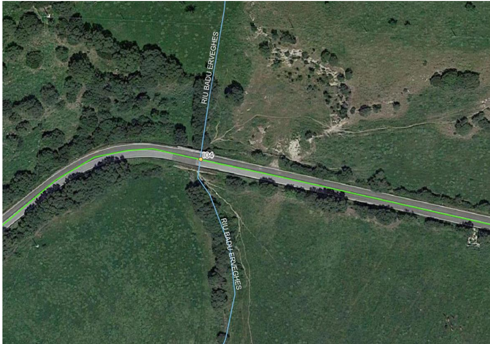
Figura 6.11 - Ubicazione interferenza I04 su ortofoto, in verde il cavidotto di connessione, in azzurro la rete idrica
