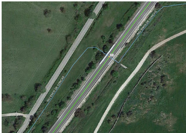
Figura 6.29 - Ubicazione interferenza I13 su ortofoto, in verde il cavidotto di connessione, in azzurro la rete idrica
