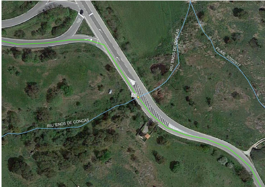
Figura 6.25 - Ubicazione interferenza I11 su ortofoto, in verde il cavidotto di connessione, in azzurro la rete idrica
