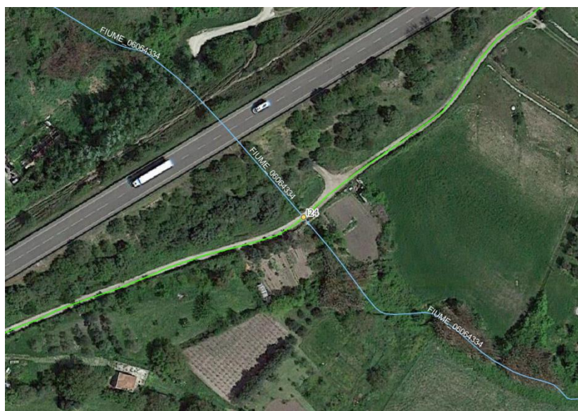
Figura 6.51 - Ubicazione interferenza I24 su ortofoto, in verde il cavidotto di connessione, in azzurro la rete idrica
