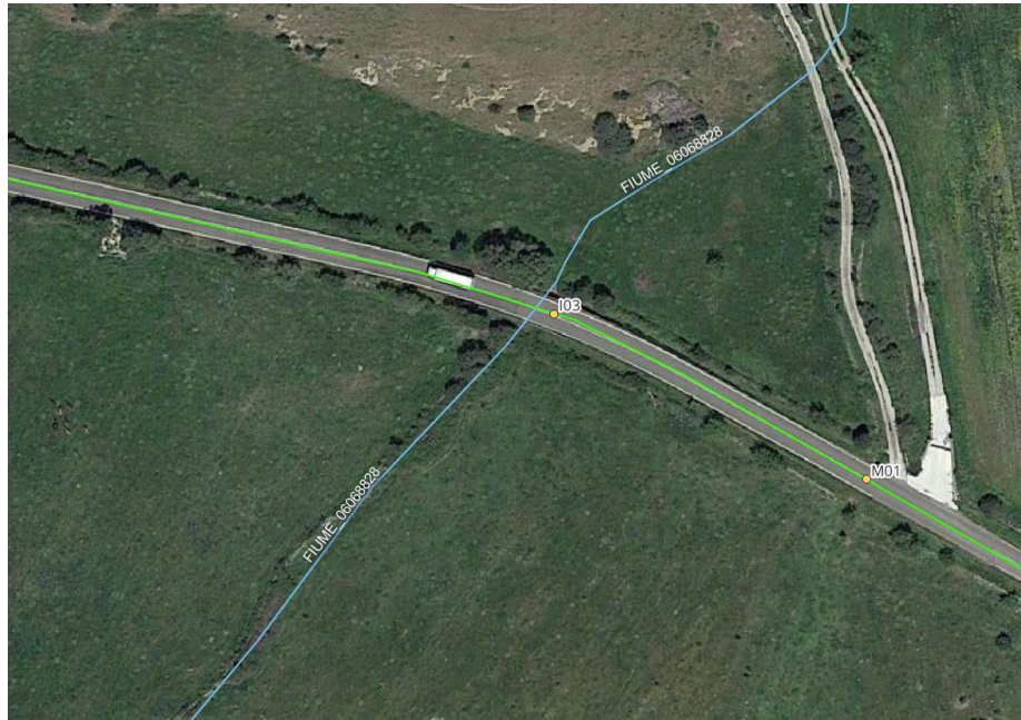
Figura 6.9 - Ubicazione interferenza I03 su ortofoto, in verde il cavidotto di connessione, in azzurro la rete idrica
