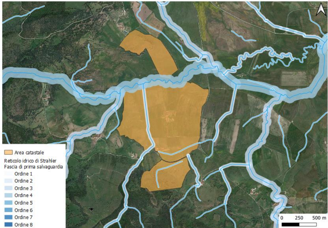
Figura 4.4 - Reticolo di Strahler e relative fasce di rispetto con l'area catastale del sito
