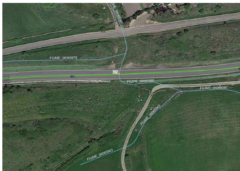
Figura 6.41 - Ubicazione interferenza I19 su ortofoto, in verde il cavidotto di connessione, in azzurro la rete idrica
