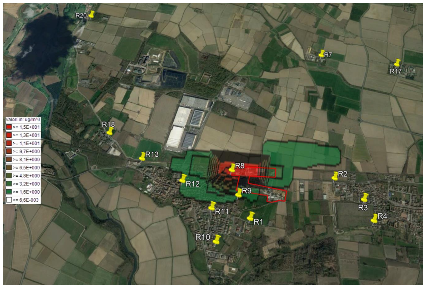
Immagine 12.7: Mappa Iso Concentrazione PM 10 . 90,4 Percentile in ogni recettore calcolati sulla media di 24 hr
