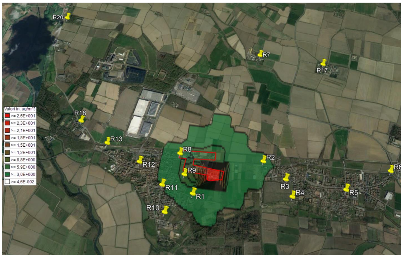
Immagine 12.5: Mappa Iso Concentrazione SO 2 . 99,7 Percentile in ogni recettore calcolati sulla media di 1 hr
