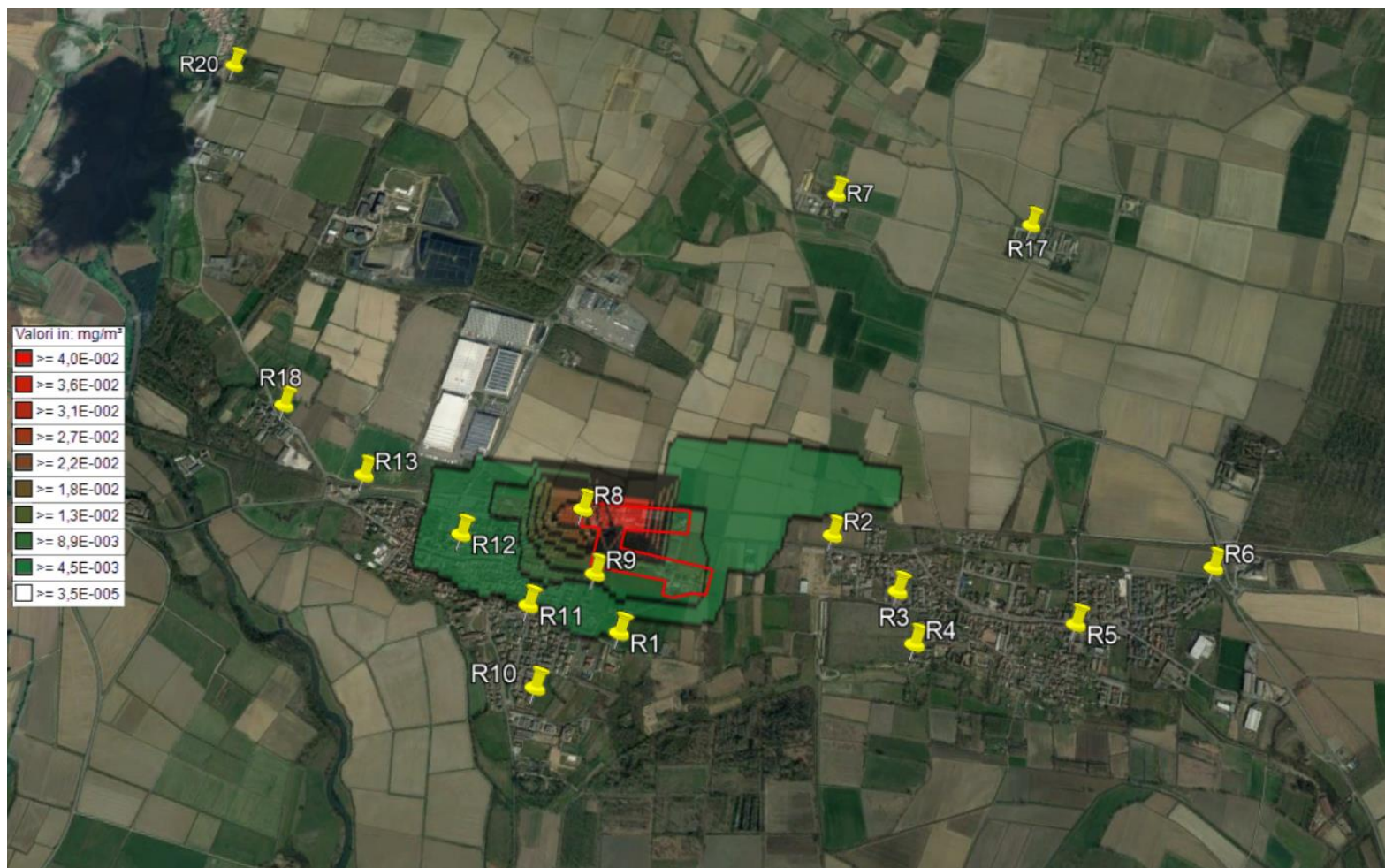
Immagine 12.3: Mappa Iso Concentrazione CO. Valori medi in ogni recettore calcolati sulla media di Media mobile su 8 ore massima giornaliera
