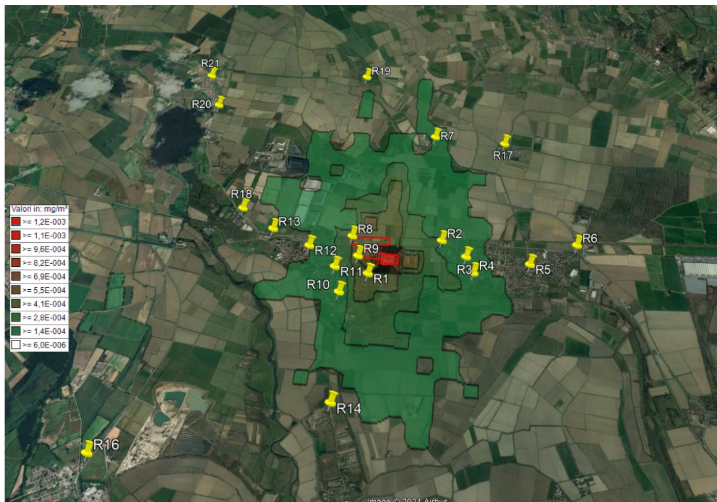
Immagine 12.10: Mappa Iso Concentrazione HCl. Valori massimi in ogni recettore calcolati sulla media di 1 hr
