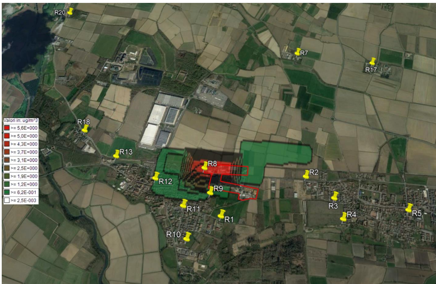
Immagine 12.6: Mappa Iso Concentrazione PM 10 . Valori medi in ogni recettore calcolati sulla media di 24 hr
