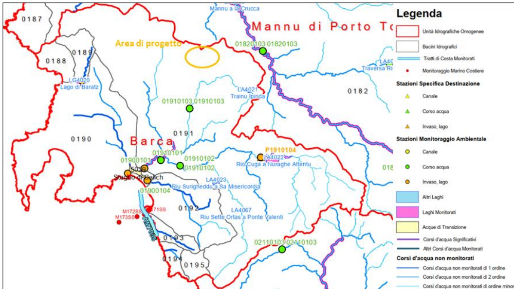
Figura 4.13. Idrografia superficiale nei dintorni dell'Area di Progetto (Fonte: Autorità di Bacino Sardegna).
