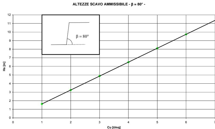
Data la variabilità delle caratteristiche geotecniche delle unità litotecniche coinvolte, l'altezza di scavo ammissibile dovrà essere determinata in corso d'opera, mediante misura in sito della coesione su parete e fondo scavo ed applicazione dei diagrammi allegati in funzione dell'angolo di inclinazione delle pareti dello scavo e della coesione rilevata.
