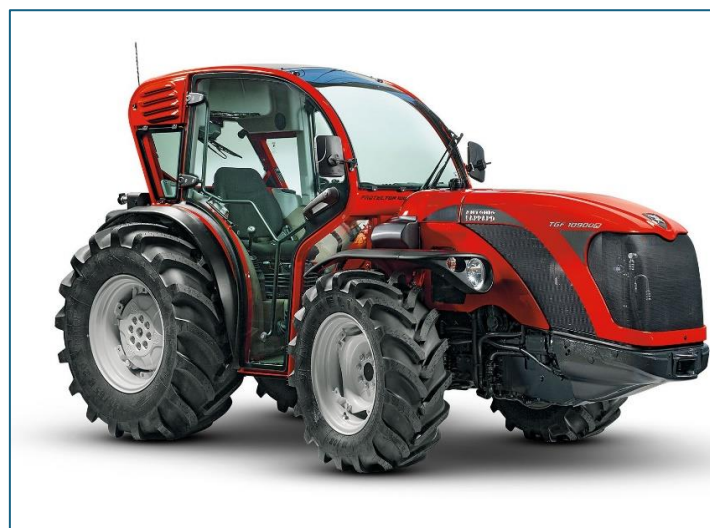
Figura 60: Esempio di trattore a pneumatici utilizzato nei frutteti
