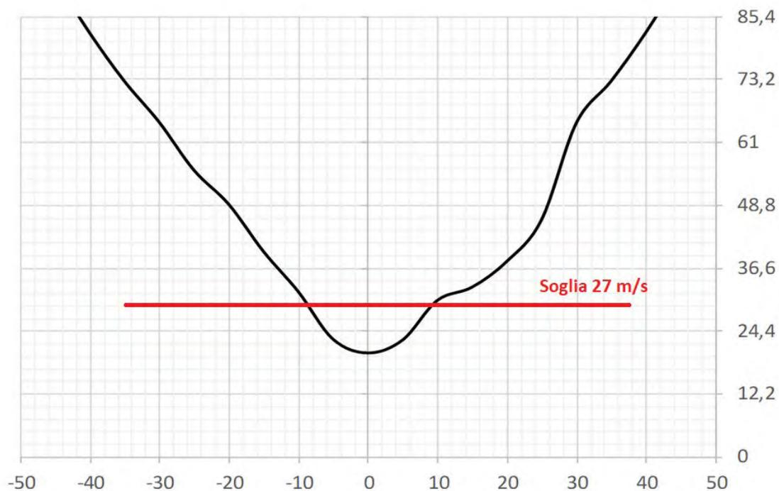
Nel grafico soprastante viene riportato l'angolo minimo necessario ad ottemperare il requisito di  $27\text{m/s}$  pari a circa un tilt di  $10^\circ$ .
