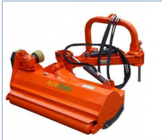
Figura 178: Esempio di trincia con il traslatore destra/sinistra
