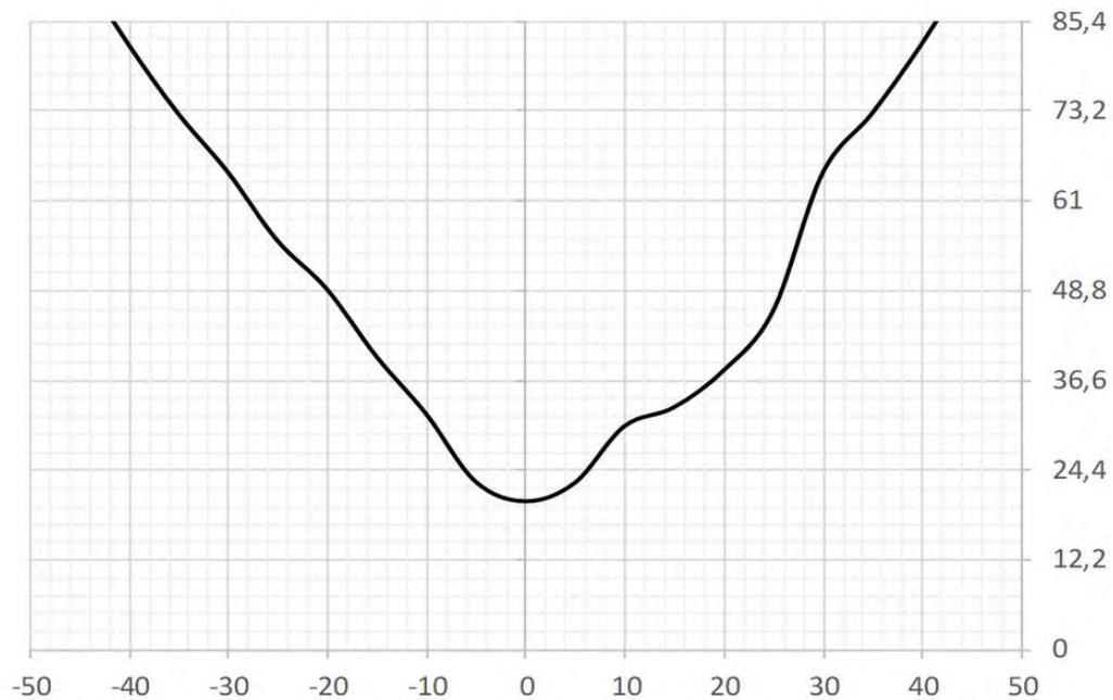
Come si può notare ad un angolo di circa  $+30^\circ$  o maggiore il valore di  $U_{cr}$  è di circa  $60\text{m/s}$  quindi di molto superiore rispetto il posizionamento a  $0^\circ$  di tilt, il che rende la posizione di protezione a  $30^\circ$  preferenziale.
