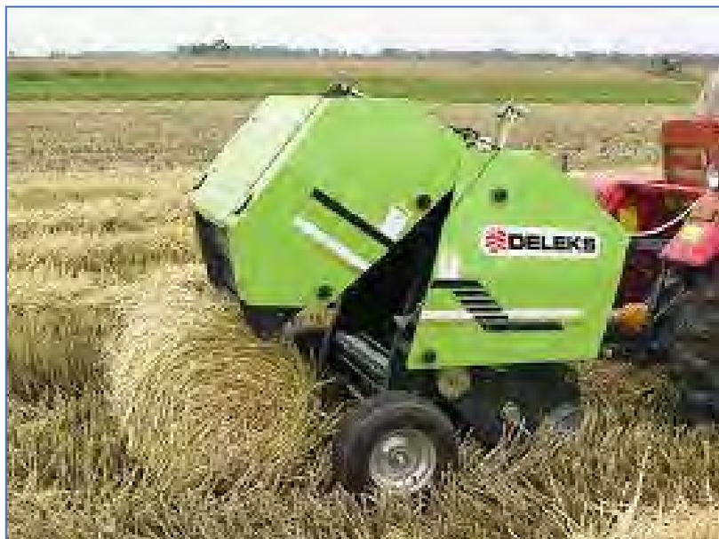
Figura 179: Esempio di mini-rotoimballatrice
