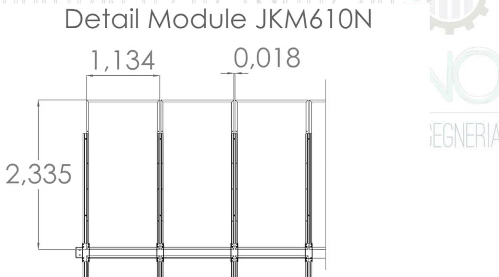
Figura 3-1: Dettaglio Modulo/Tracker
