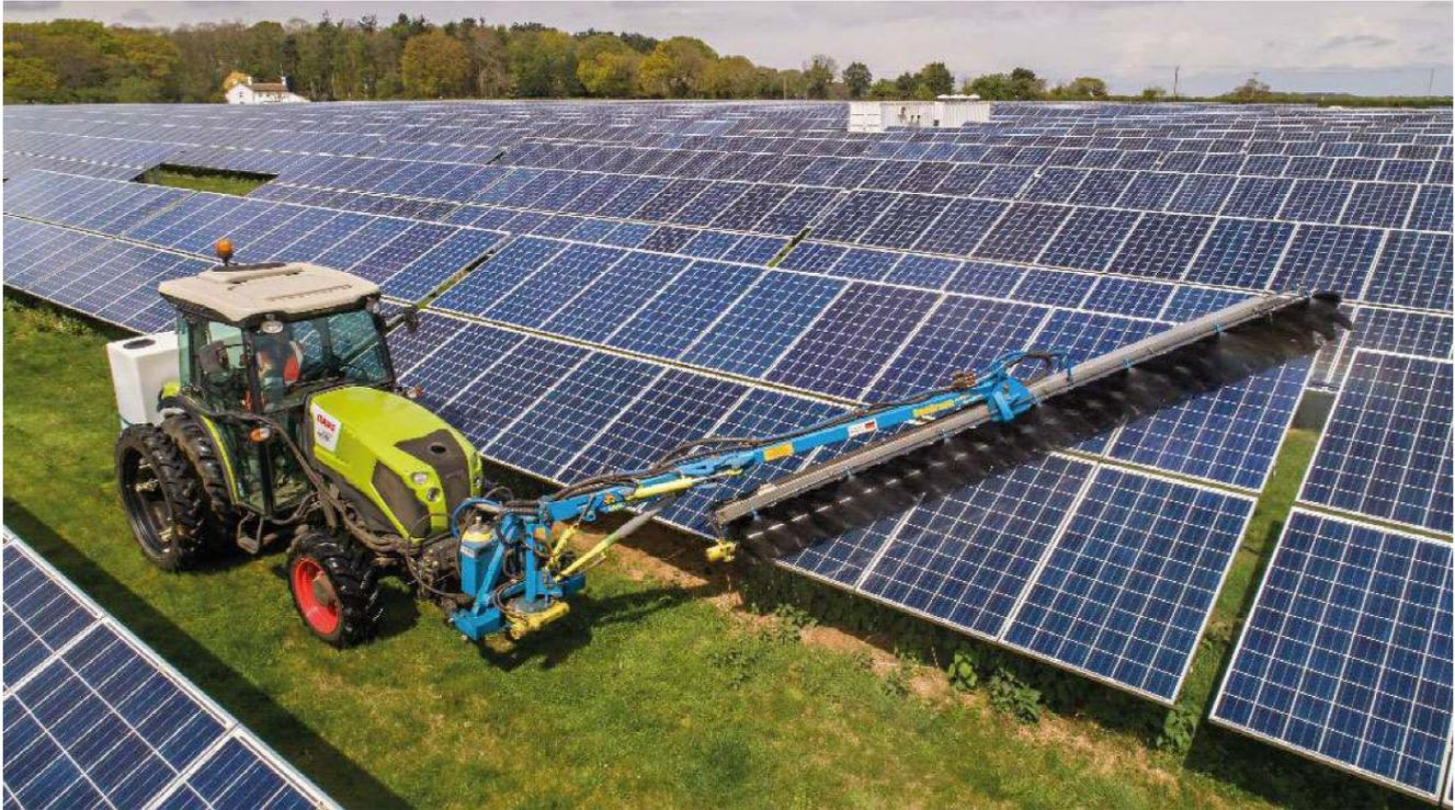
*Esempio di macchina per la pulizia dei moduli FV*
