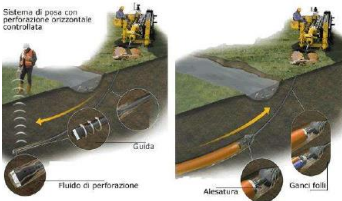
Posa in opera tubazione con trivellazione teleguidata
