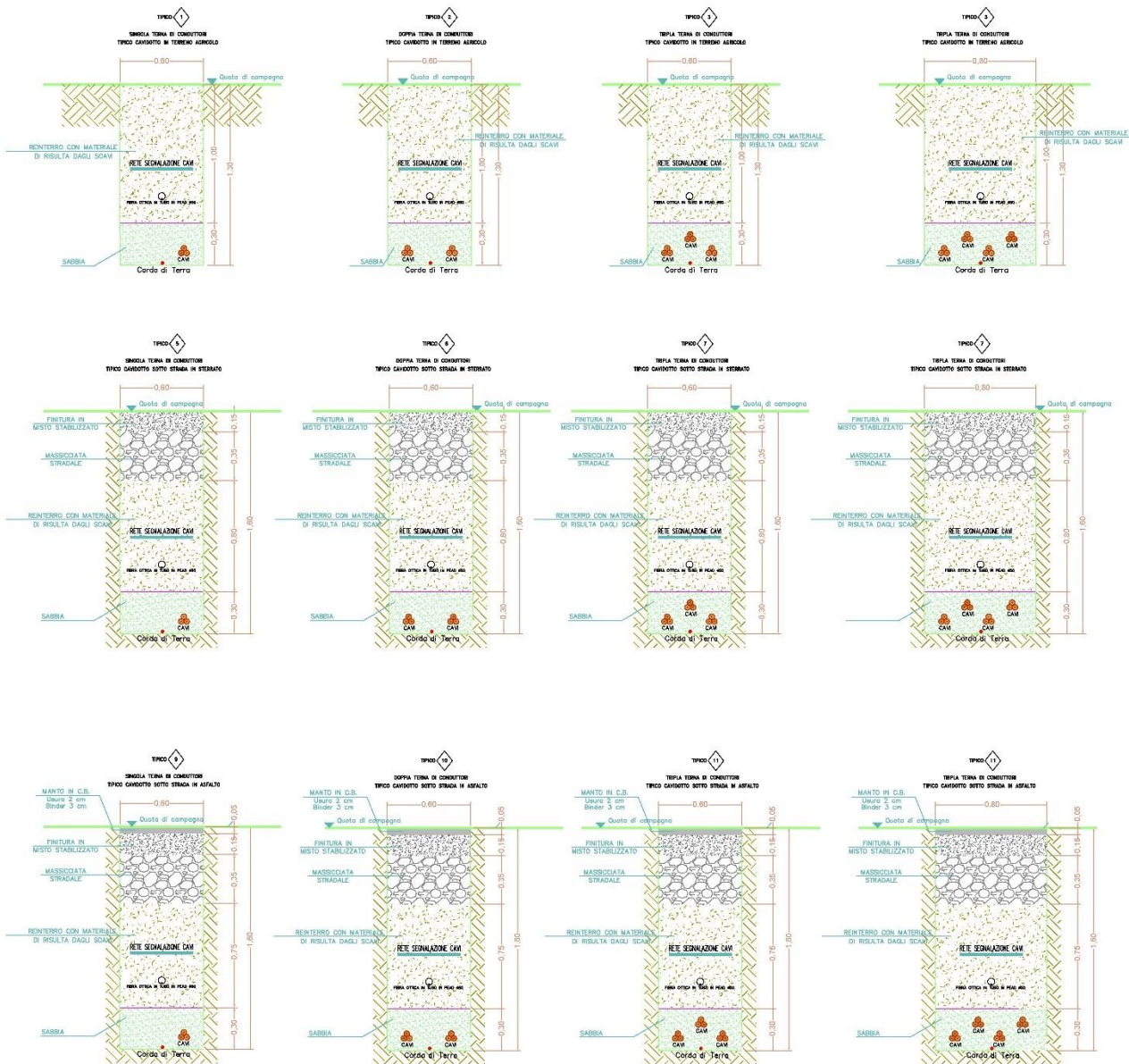
Sezioni tipiche cavidotto
