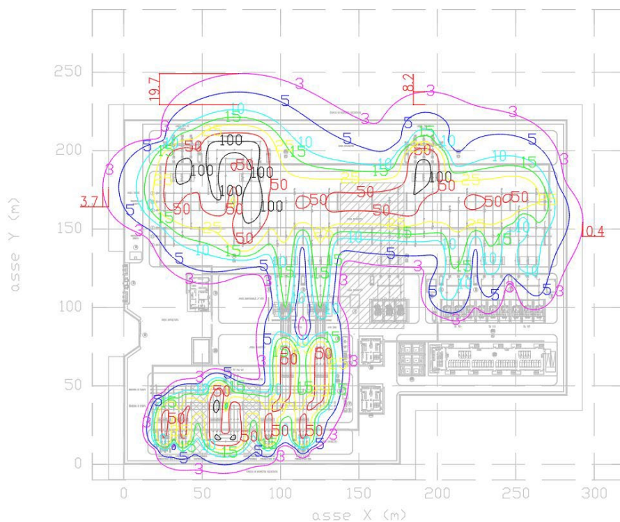
Curve isolivello del campo di Induzione Magnetica B - 1 metro
