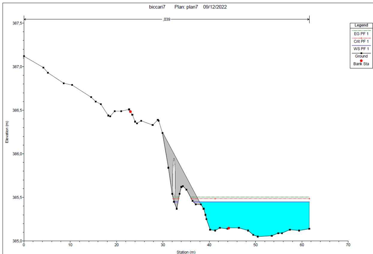
*Simulazione del culvert inserito (tombino di diametro 50 cm)*
