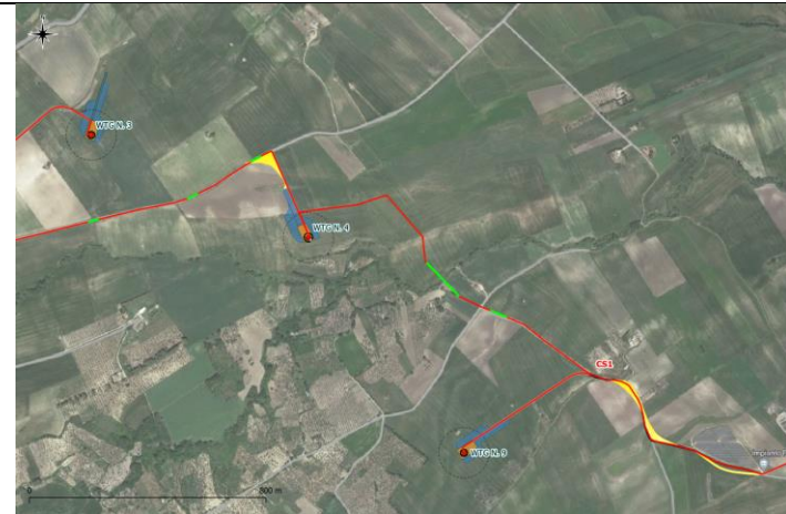
VARIAZIONE CAVIDOTTO DI COLLEGAMENTO WTG 4 – WTG 9
