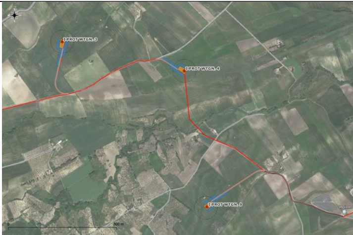
I PROTOCOLLO CAVIDOTTO DI COLLEGAMENTO WTG 4 – WTG 9
