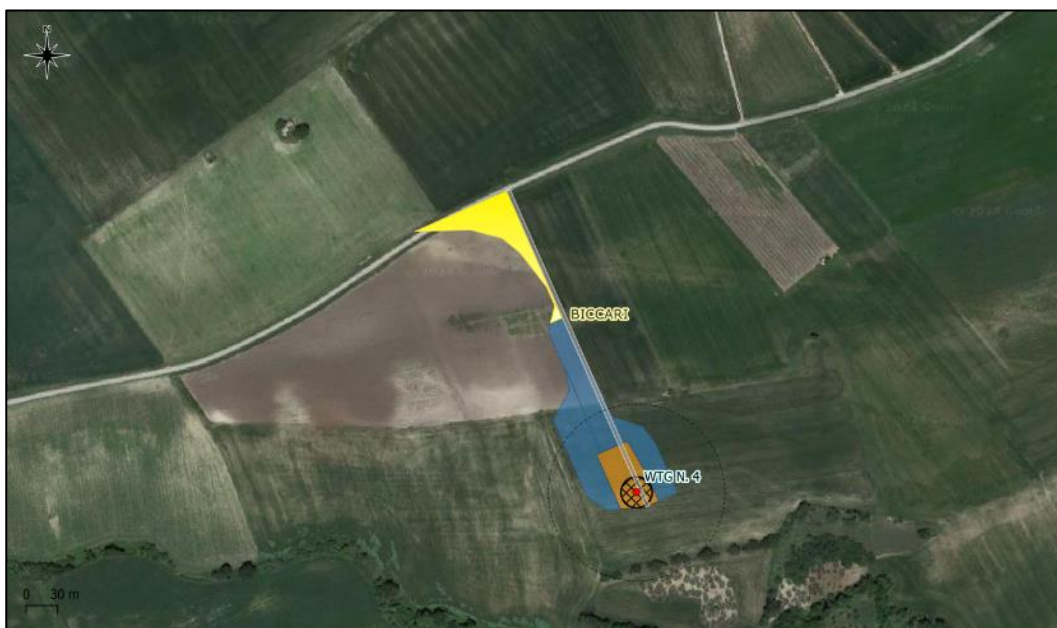
WTG 4 – Piazzola temporanea (in blu), permanente (in arancione), viabilità di accesso (in grigio) e slargo (in giallo)
