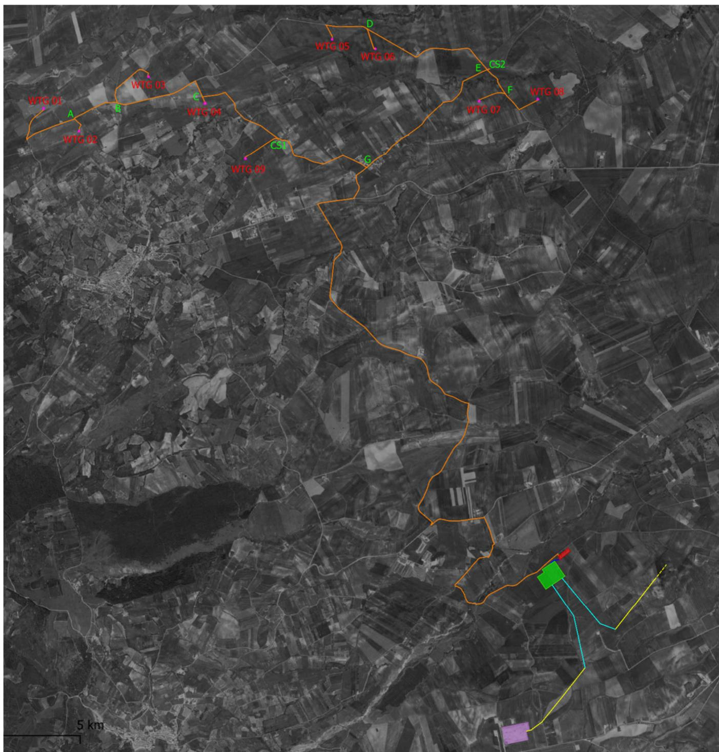
Per la valutazione dei campi elettromagnetici generati dagli elettrodotti interrati con tensione di esercizio 30 kV, sono state individuate le seguenti tratte (cfr. figura precedente) e relative correnti di impiego:
