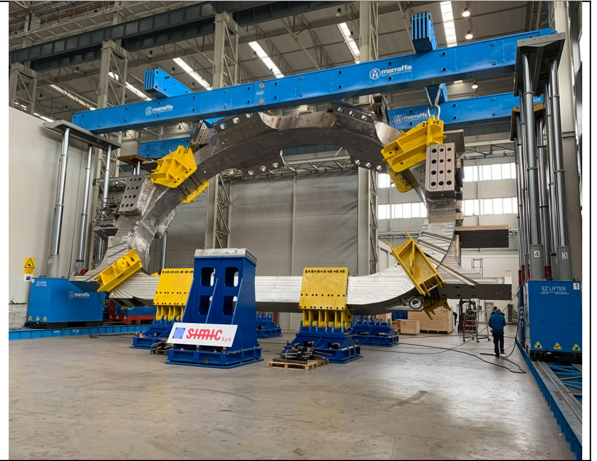
Gantry Crane in fase di movimentazione
