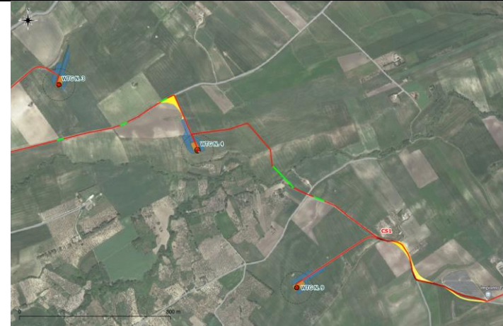
VARIAZIONE CAVIDOTTO DI COLLEGAMENTO WTG 4 – WTG 9
