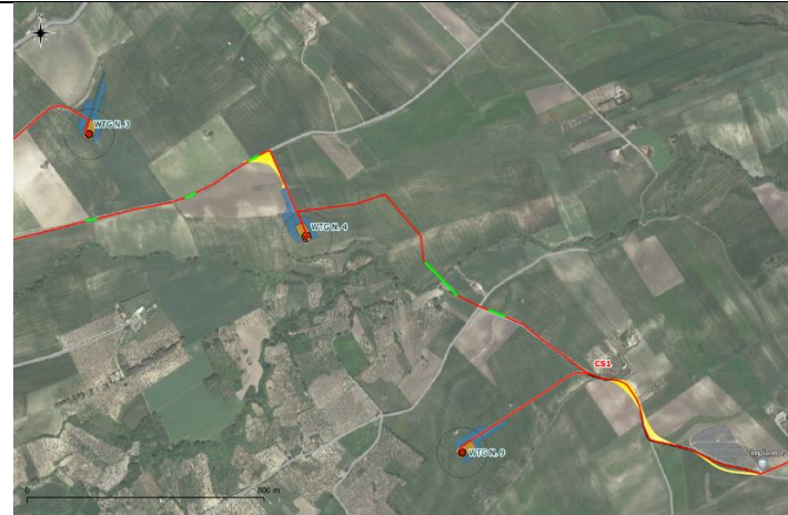
VARIAZIONE CAVIDOTTO DI COLLEGAMENTO WTG 4 – WTG 9
