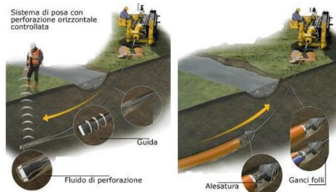
Fig. 0.13: Posa in opera tubazione per alloggio cavi
