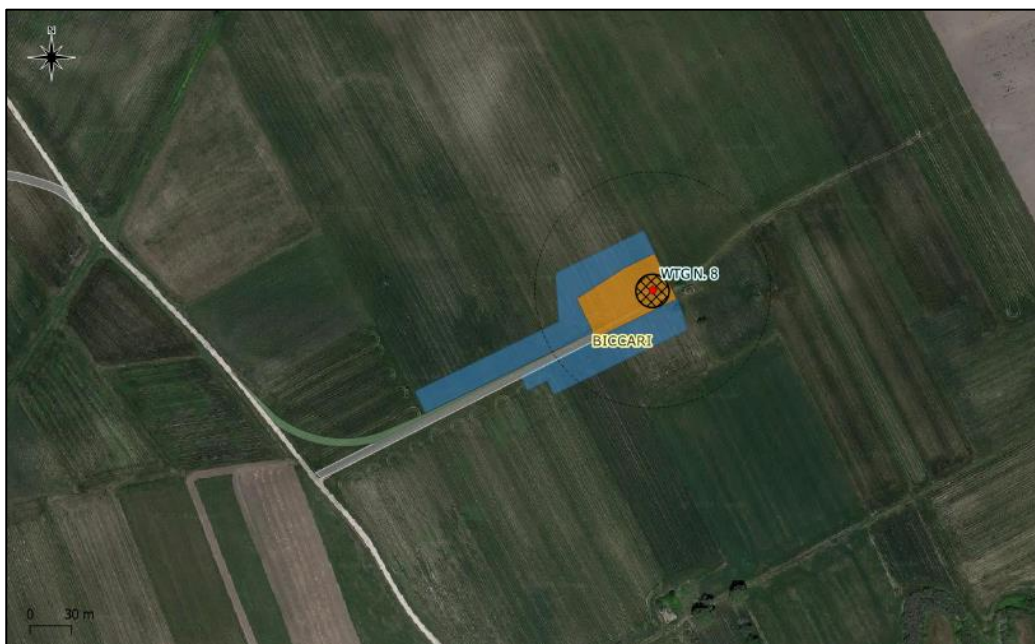
WTG 8 – Piazzola temporanea (in blu), permanente (in arancione) e viabilità di accesso (in grigio)
