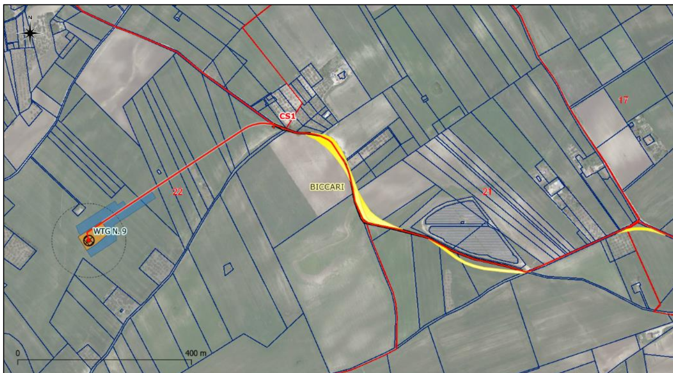
WTG 9: Accesso attraverso strada comunale a sud. Adeguamento della viabilità esistente. Attraverso degli slarghi ad hoc si accede alla WTG 9.
