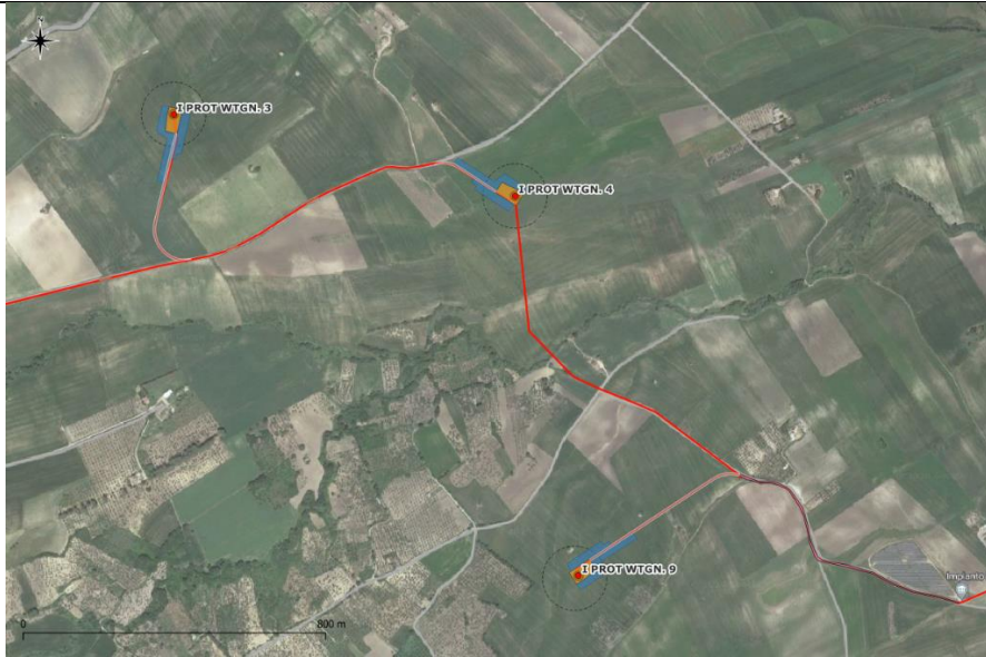
I PROTOCOLLO CAVIDOTTO DI COLLEGAMENTO WTG 4 – WTG 9
