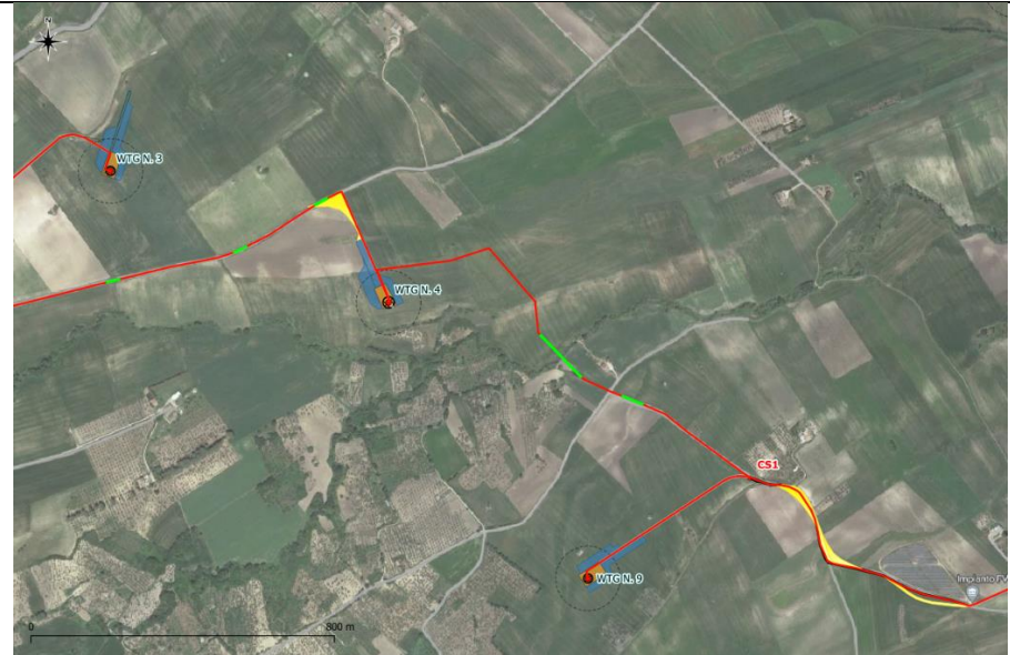
VARIAZIONE CAVIDOTTO DI COLLEGAMENTO WTG 4 – WTG 9
