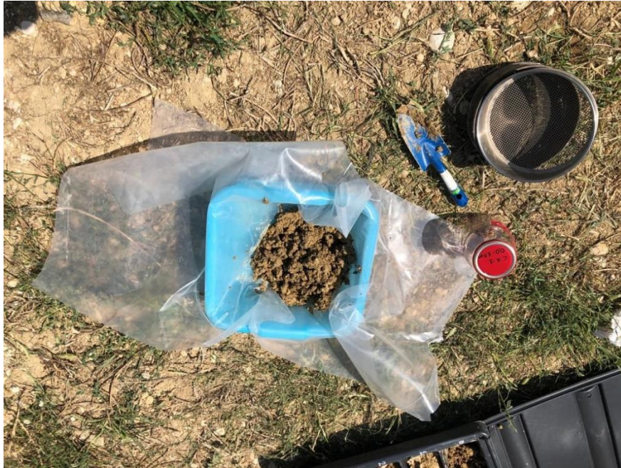
Figura 8-2 - Setacciatura del terreno da campionare
