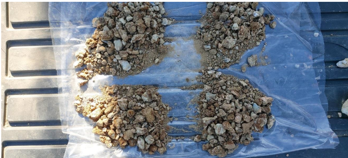
Figura 8-3 - Quartatura del terreno da campionare
