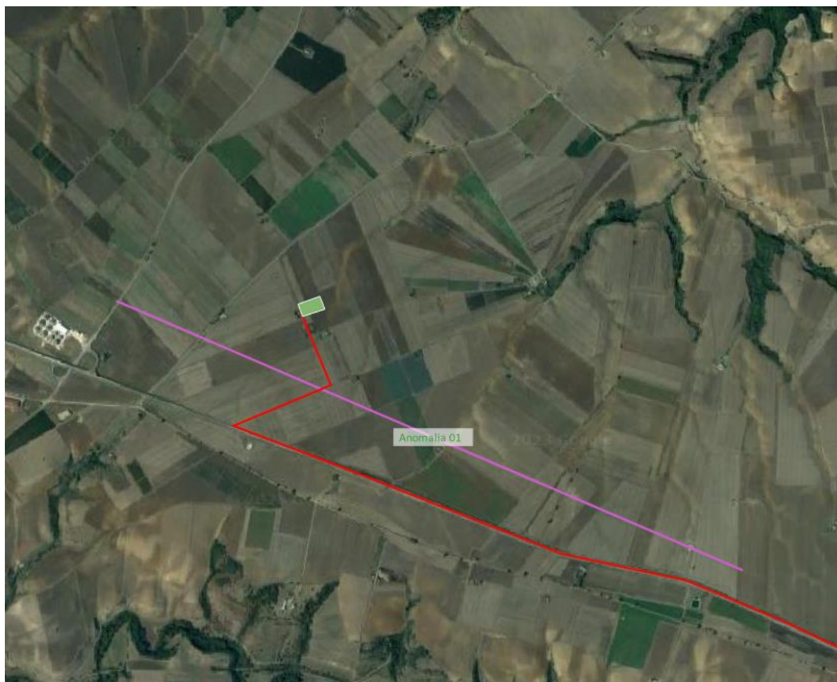
Fig. 5 Anomalia da satellite riconducibile ad un'opera moderna (in viola) e il tracciato delle opere in progetto (in rosso).
