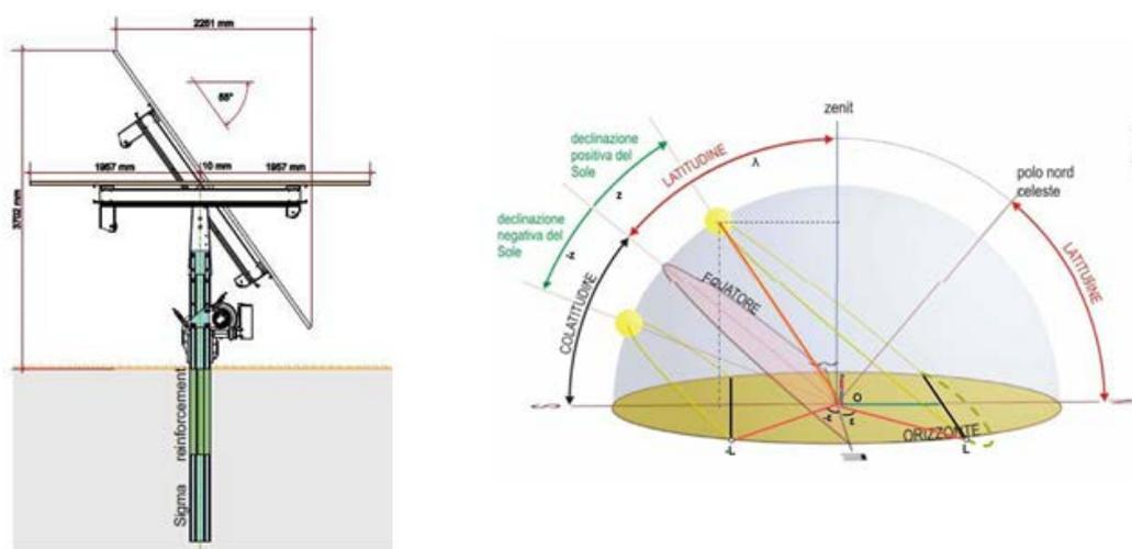
*Figura 15 - Tracker fotovoltaico ad inseguimento mono assiale est-ovest*
