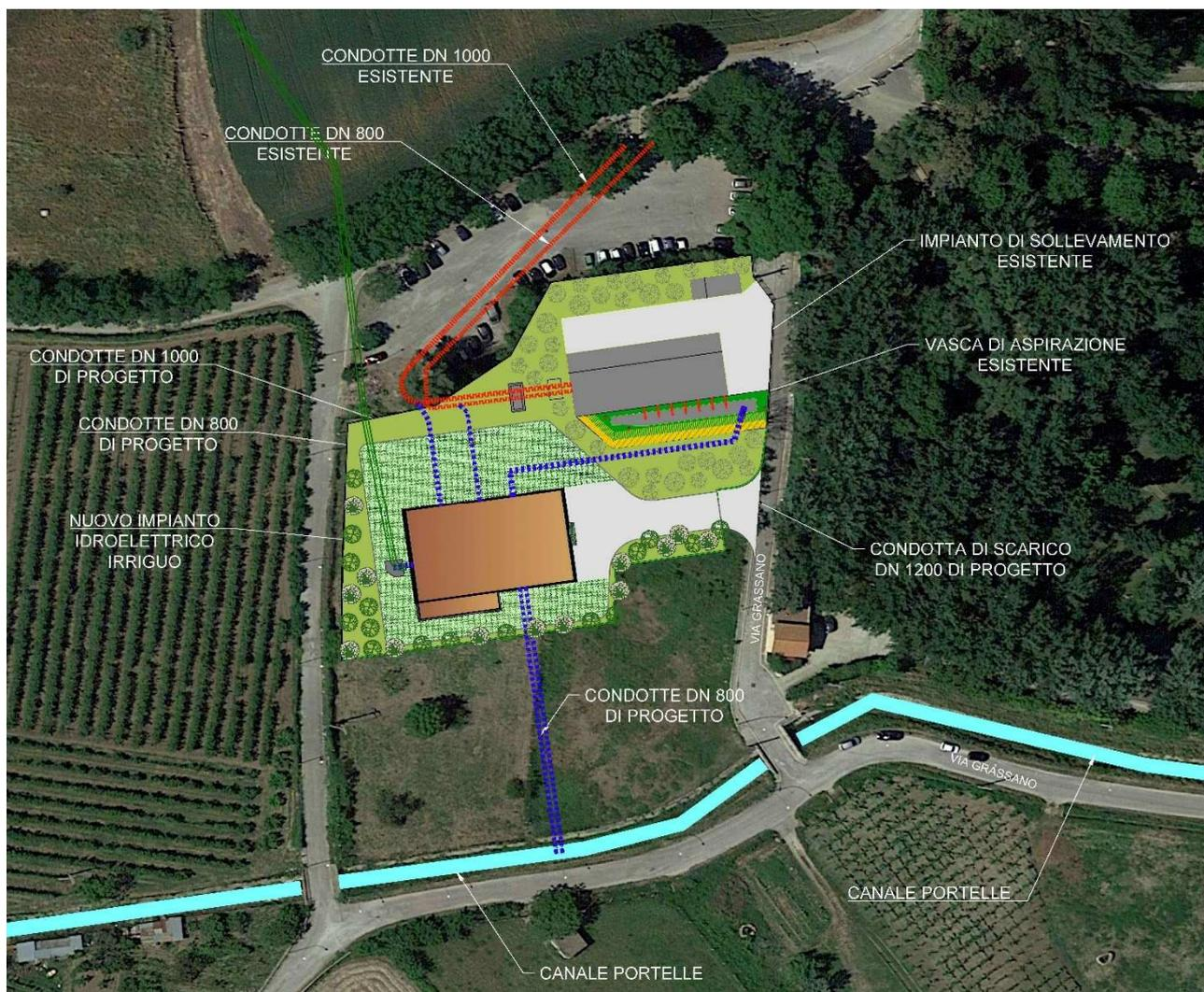
Fig. 2.21- Impianto idroelettrico opere irrigue-planimetria
