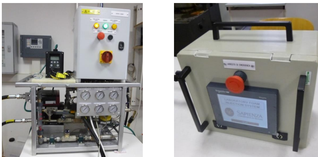
Figura 7. Generatore di schiuma messo a punto presso il Dipartimento di Ingegneria Strutturale e Geotecnica (DISG) dell'Università di Roma "La Sapienza".
