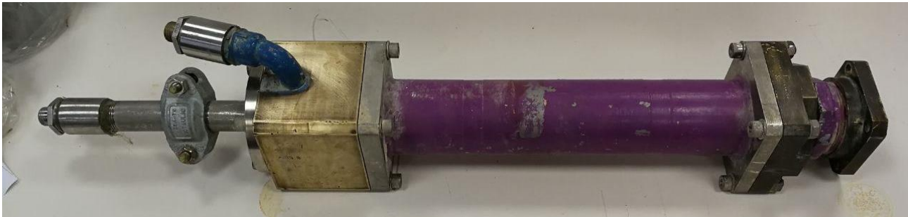
Figura 8. Lancia di generazione della schiuma disponibile presso il Dipartimento di Ingegneria Strutturale e Geotecnica (DISG) dell'Università di Roma "Sapienza" utilizzata per la sperimentazione.
