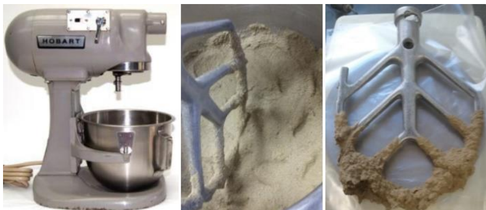
Figura 11. Attrezzatura per il mixing test.
