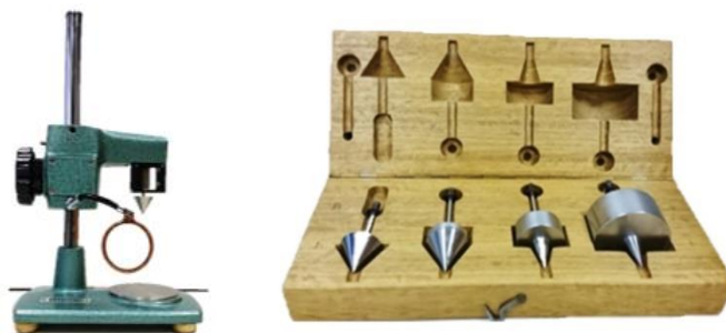
Figura 13. Attrezzatura per il fall cone test.
