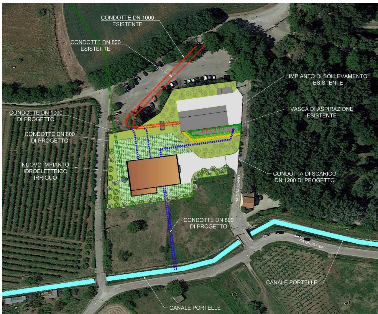
Fig. 2.21- Impianto idroelettrico opere irrigue-planimetria
