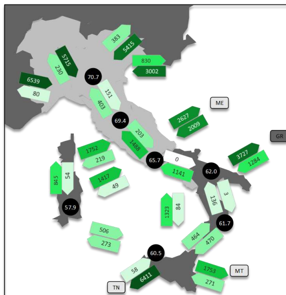
Figura 4– Flussi di energia (TWh) e ore di congestione, scenario 2040 NT IT
