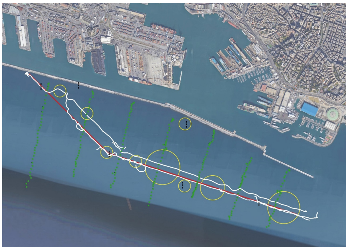
Fig.3 Identificazione dei potenziali target (cerchi gialli), tracce ROV GE.CO. (colore bianco), transetti ROV DISTAV (tratteggio nero), transetto ROV PFE (traccia verde). In rosso è delineato l'asse della nuova diga.
