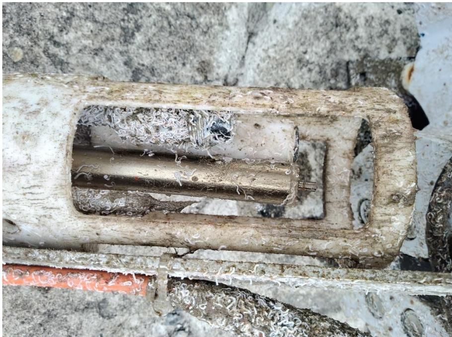
Correntometro (sopra) e sonda (sotto) della stazione FL.
