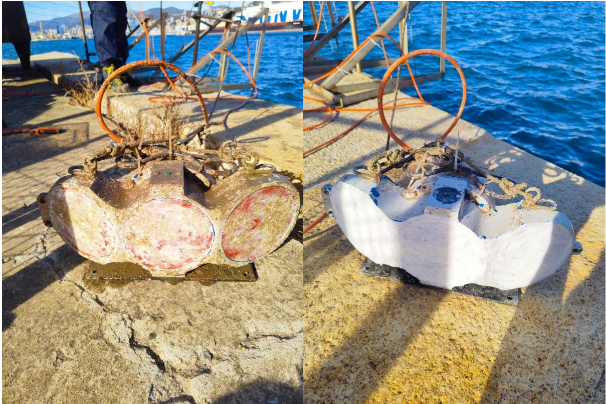
Correntometro della stazione di levante FL prima e dopo la manutenzione.
