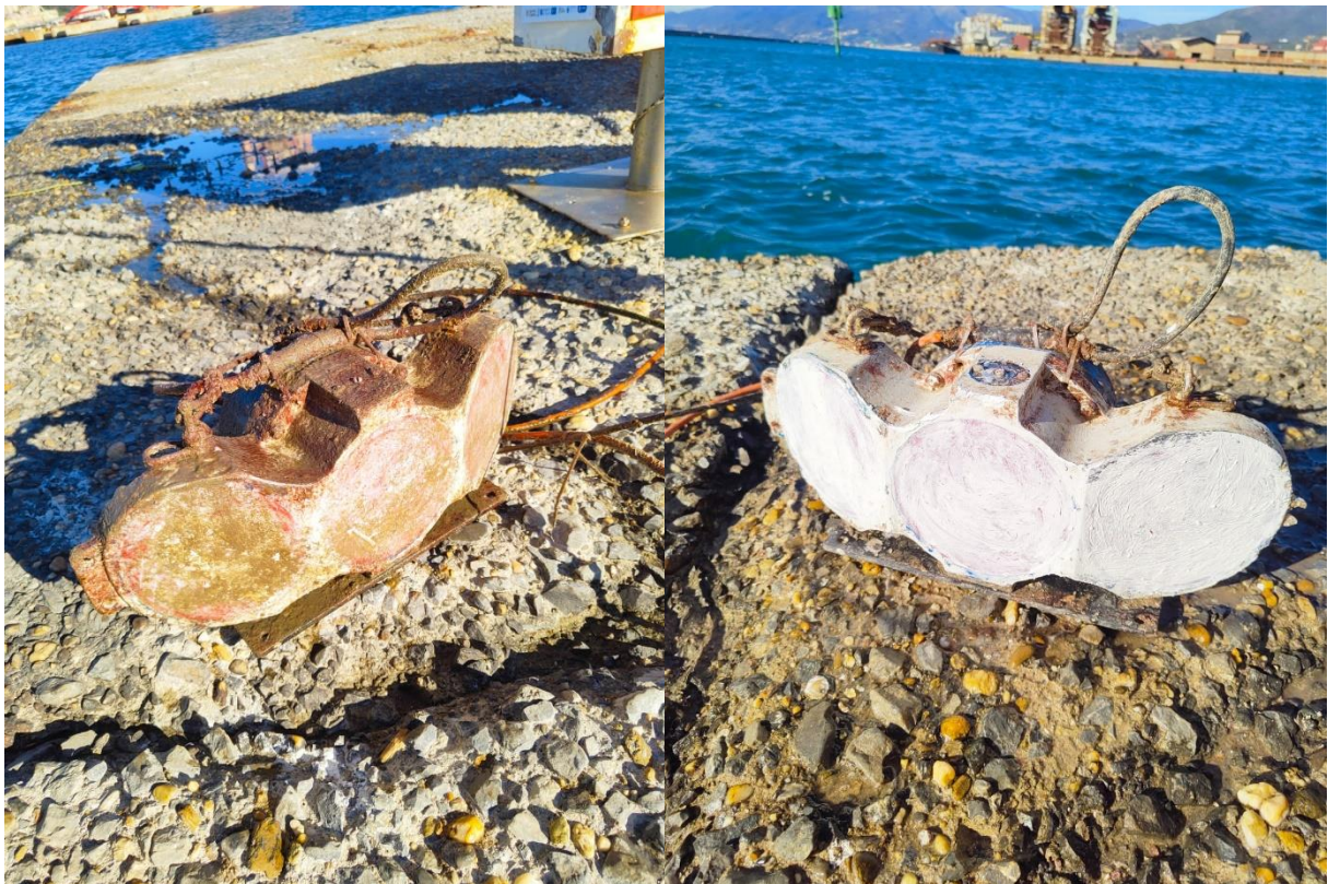
Correntometro della stazione di ponente-Polcevera FP prima e dopo la manutenzione.
