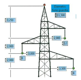
Nella figura seguente è riportato il calcolo del campo elettrico generato dalla linea 132 kV semplice terna presa in considerazione:
