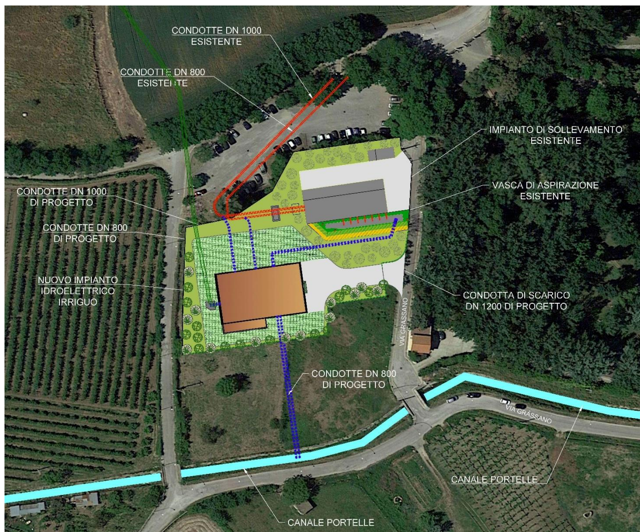
Figura 20- Impianto idroelettrico opere irrigue-planimetria
