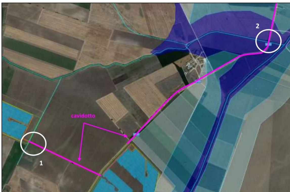
**Figura 42 – Interferenze cavidotto MT (in viola) con il reticolo idraulico**
