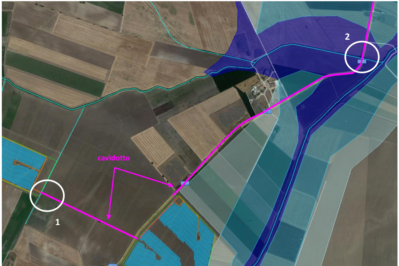
Planimetria attraversamenti con tracciato del cavidotto
