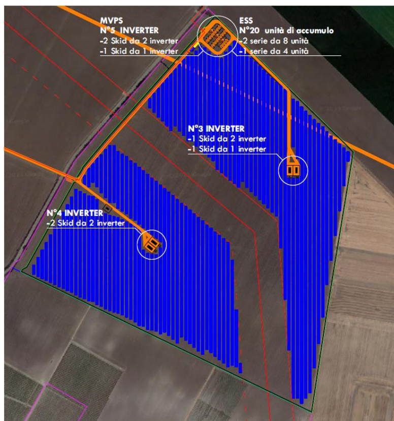
Figura 9 - Campo EST ubicazione POWER SKID – MVPS - ESS
