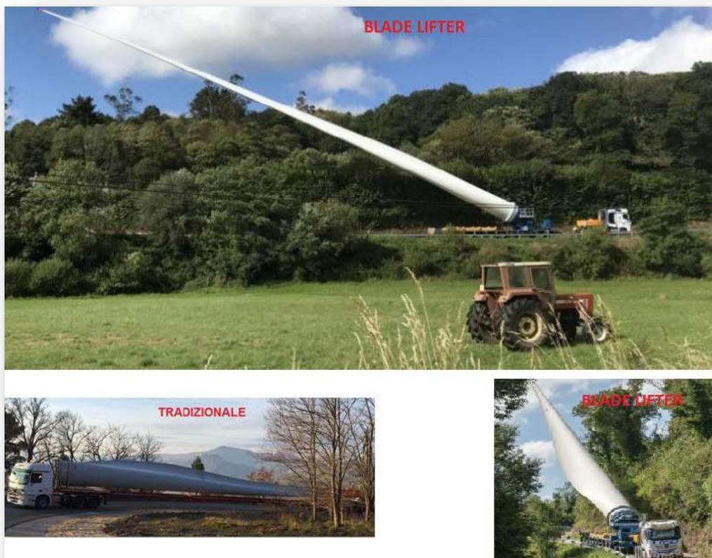
*Figura 22 – esempi di trasporto tradizionale e soluzione con cambio della configurazione di carico durante il percorso (blade lifter)*
