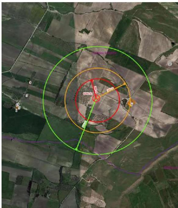
**Figura 14 – Estratto elaborato n. EDP0035 (Verifica delle distanze minime dell'impianto dai fabbricati WTG\_01)**
