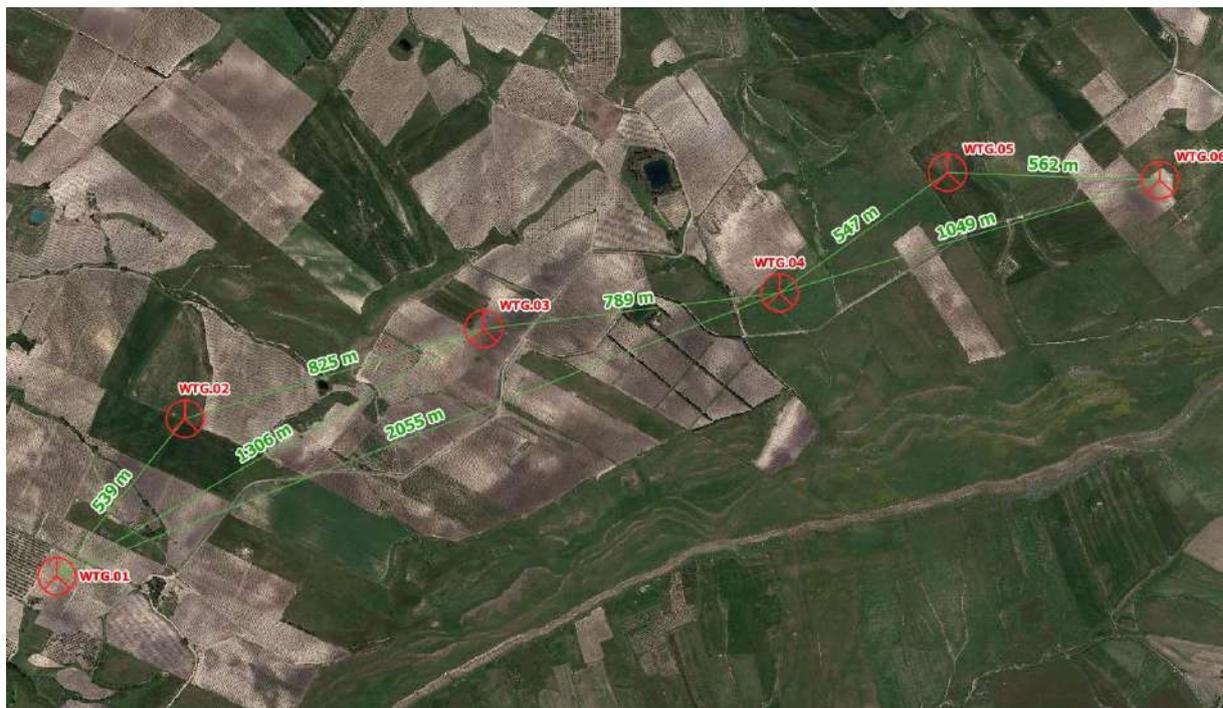
Figura 18 - Posizione aerogeneratori e relative interdistanze
