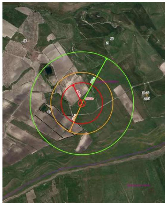
Figura 17 - Estratto elaborato n. EDP0038 (Verifica delle distanze minime dell'impianto dai fabbricati WTG\_04)
