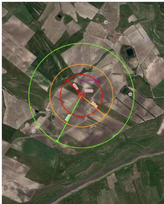
Figura 16 - Estratto elaborato n. EDP0037 (Verifica delle distanze minime dell'impianto dai fabbricati WTG\_03)
