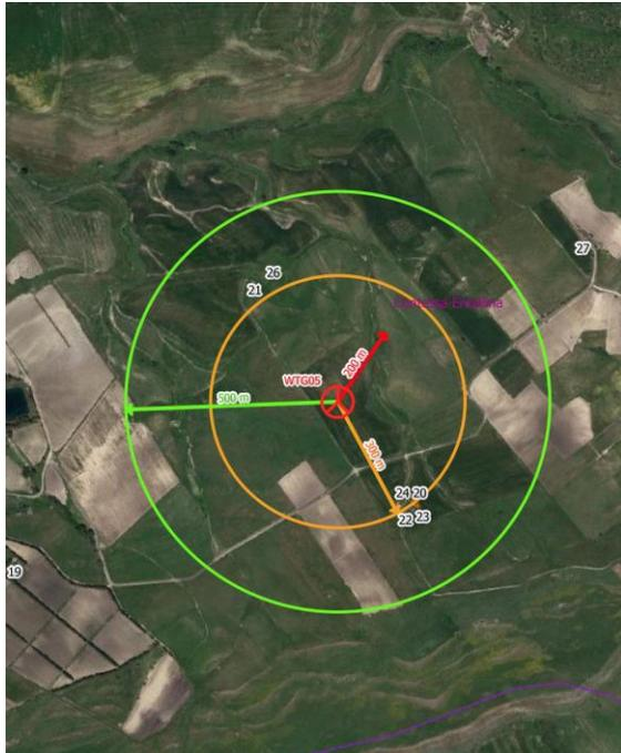
**Figura 9 - Estratto elaborato n. EDP0039 (Verifica delle distanze minime dell'impianto dai fabbricati WTG\_05)**
