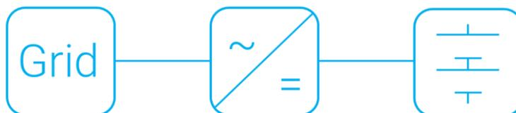
*Figura 25 -Schema semplificato di un convertitore monostadio*
