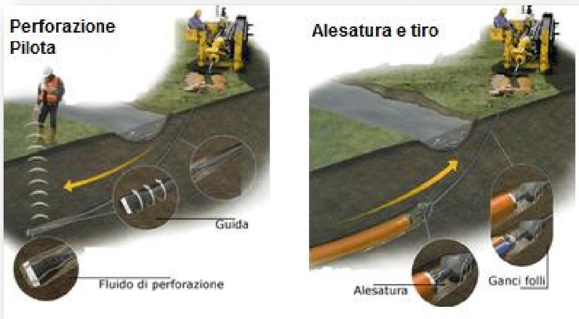
Figura 38 - Tecnologia di trivellazione orizzontale controllata (TOC)
