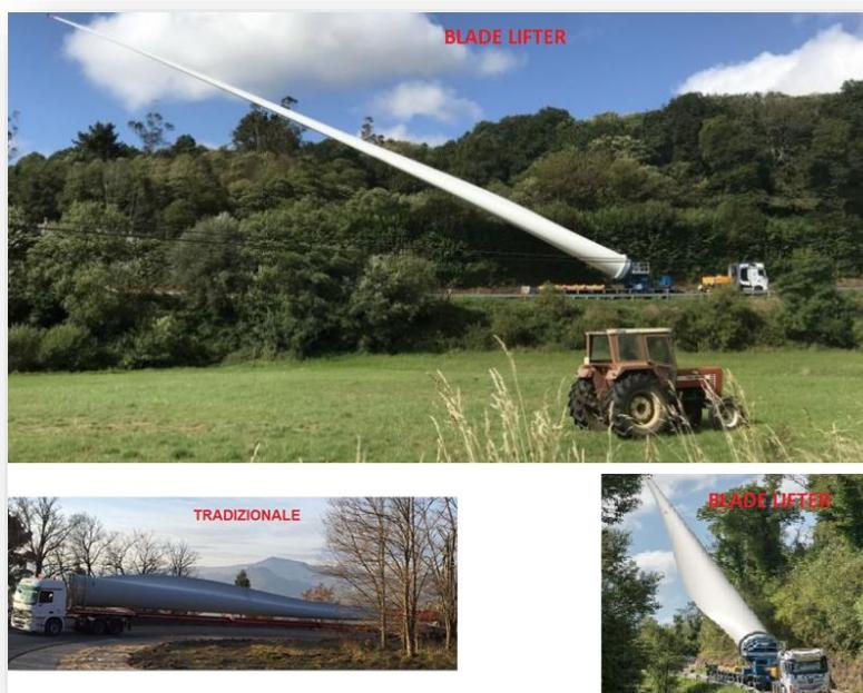
**Figura 29 - esempi di trasporto tradizionale e soluzione con cambio della configurazione di carico durante il percorso (blade lifter)**
