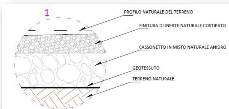
Figura 32 - schema rappresentativo del pacchetto stradale
