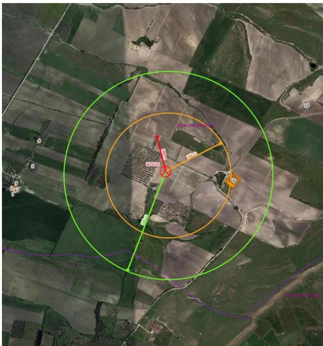
**Figura 5 – Estratto elaborato n. EDP0035 (Verifica delle distanze minime dell'impianto dai fabbricati WTG\_01)**
