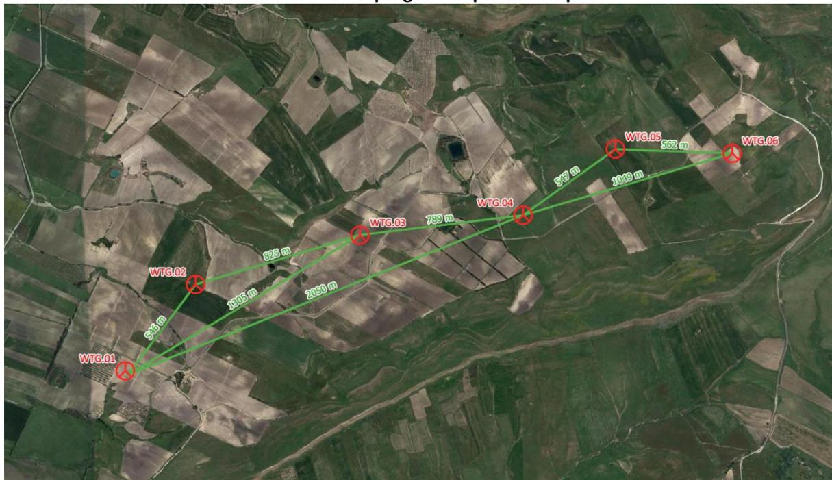
Figura 4 - Posizione aerogeneratori e relative interdistanze
