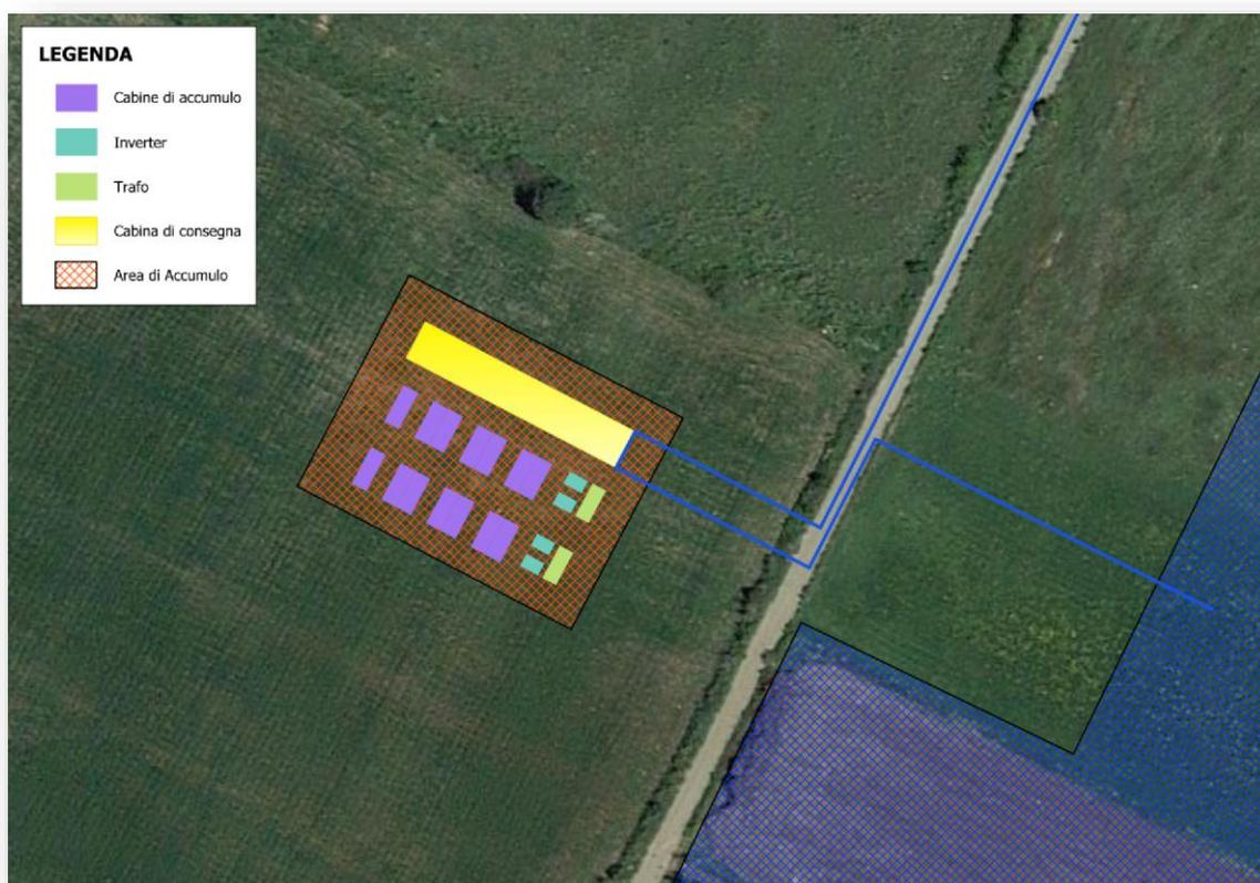
Figura 17 – disposizione layout BESS
