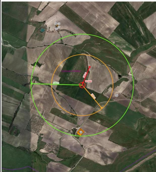
**Figura 6 - Estratto elaborato n. EDP0036 (Verifica delle distanze minime dell'impianto dai fabbricati WTG\_02)**
