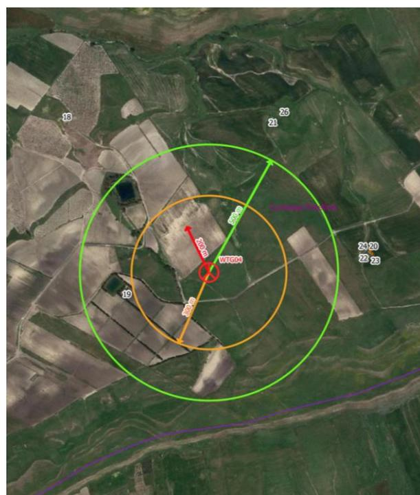
**Figura 7 - Estratto elaborato n. EDP0037 (Verifica delle distanze minime dell'impianto dai fabbricati WTG\_03)**
