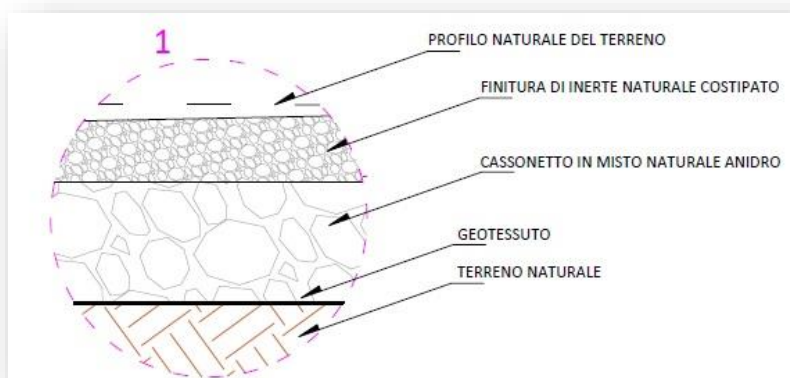
Figura 18 - schema rappresentativo del pacchetto stradale
