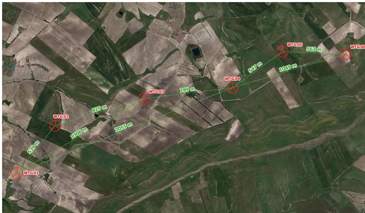
Figura 5 - Posizione aerogeneratori e relative interdistanze
