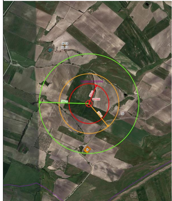
Figura 15 - Estratto elaborato n. EDP0036 (Verifica delle distanze minime dell'impianto dai fabbricati WTG_02)
