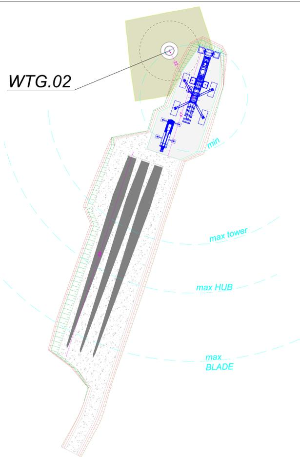
CONFIGURAZIONE 4 - MONTAGGIO LAME - SCALA 1:500
