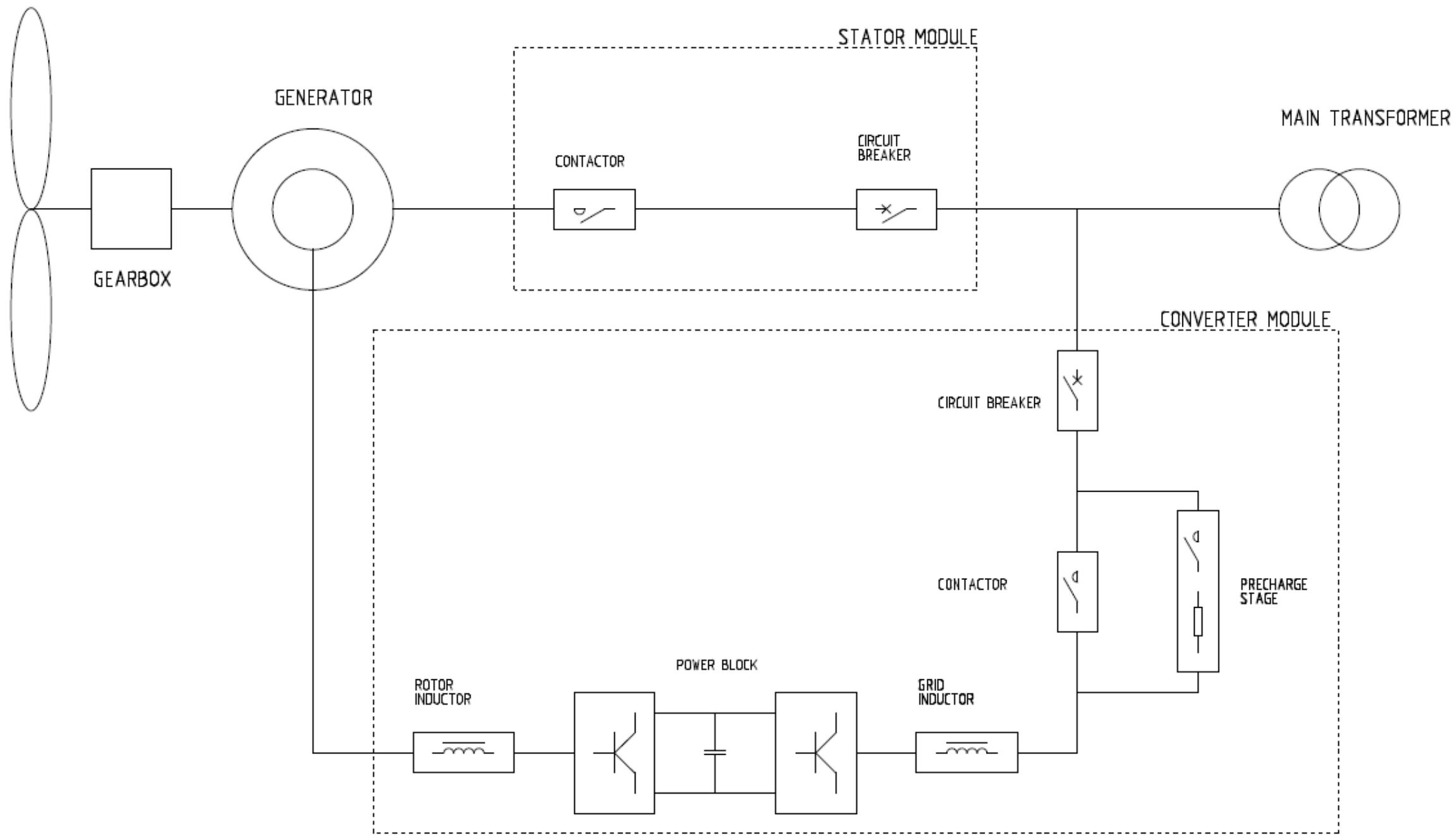
Schema funzionale tipo Aerogeneratore SG 170
