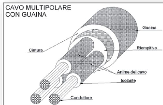
Figura 1 - Cavo multipolare con guaina
