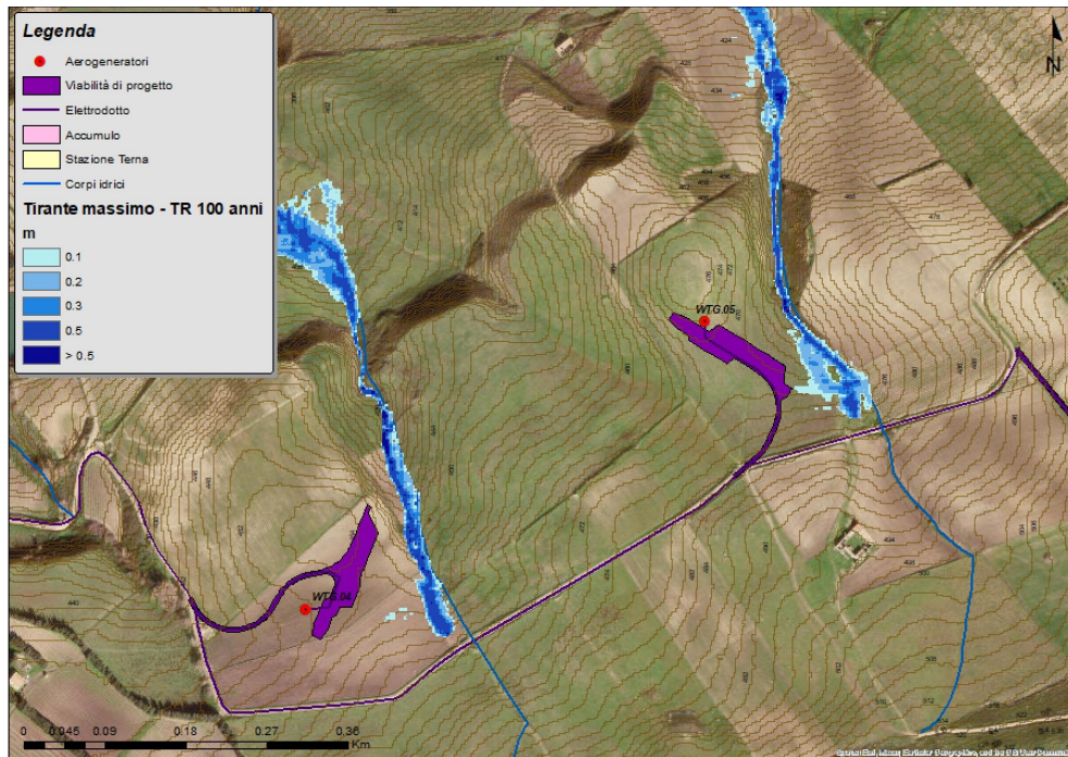
Figura 7-7 - Distribuzione dei tiranti durante il passaggio dell'onda di piena con Tr 100 anni – WTG 04 e WTG 05
