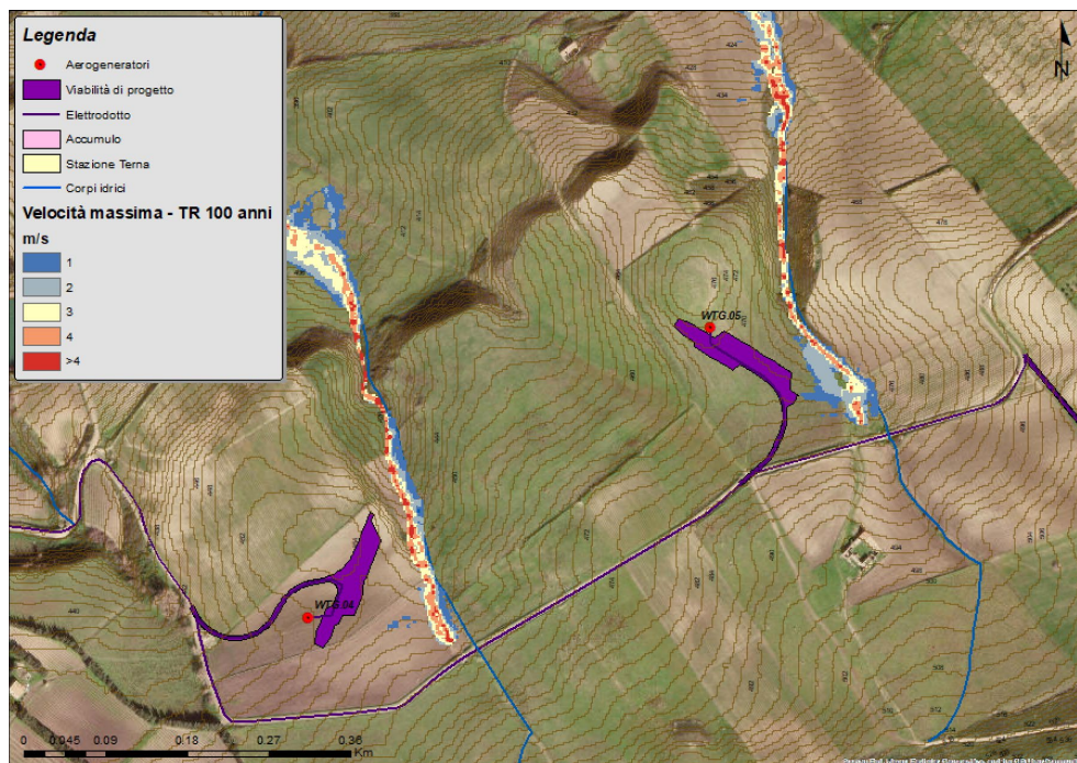
Figura 7-8 - Distribuzione delle velocità durante il passaggio dell'onda di piena con Tr 100 anni – WTG 04 e WTG 05
