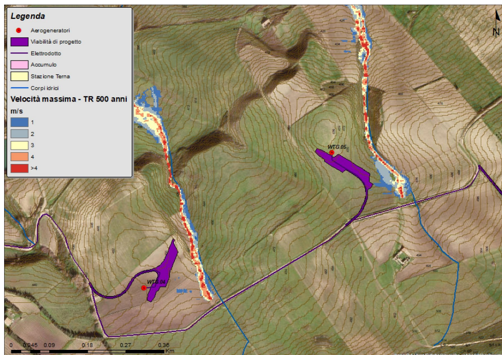
Figura 7-12 - Distribuzione delle velocità durante il passaggio dell'onda di piena con Tr 200 anni – WTG 04 e WTG 05
