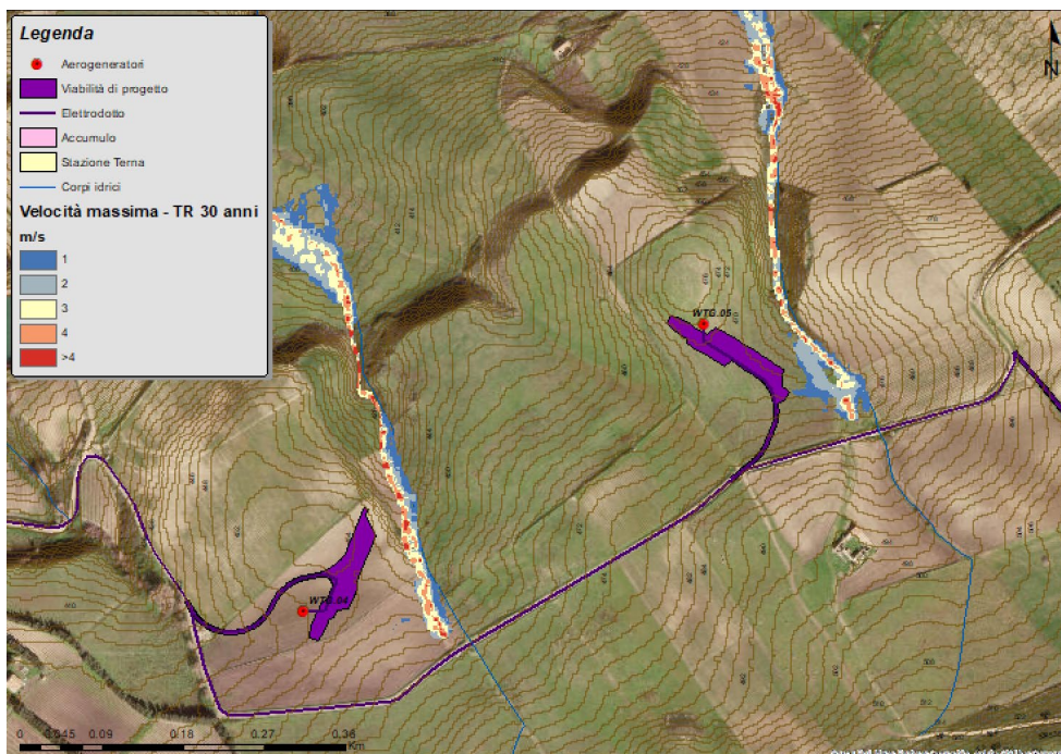
Figura 7-6 - Distribuzione delle velocità durante il passaggio dell'onda di piena con Tr 30 anni – WTG 04 e WTG 05
